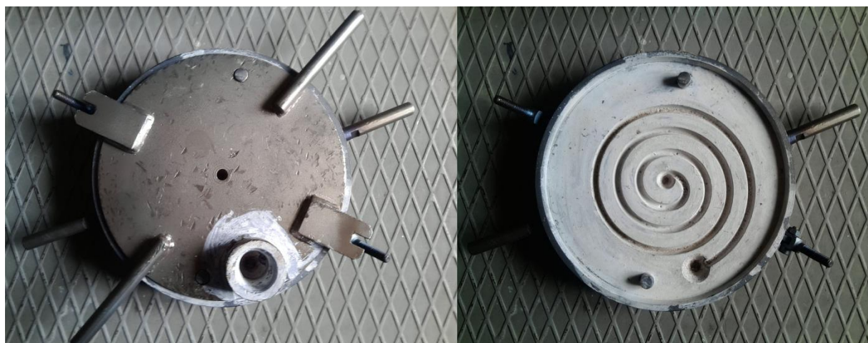
Рисунок 2.13 – Металлическая форма для получения проб формозаполняемости [3]
