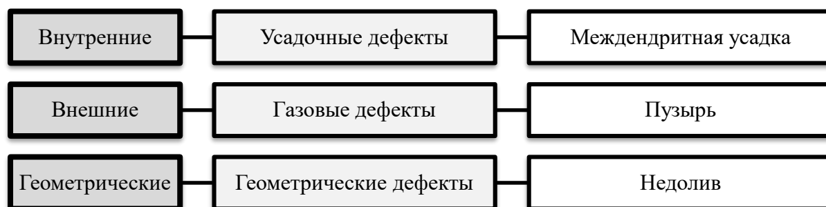
Рисунок 1.2 – Пример трехуровневой классификации дефектов литья [37]
