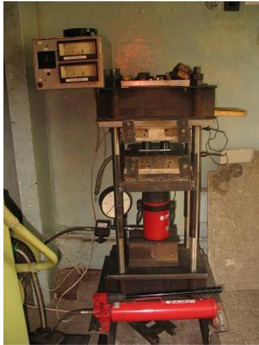
Рисунок 2.1 – Пресс вулканизационный лабораторный 250x250
