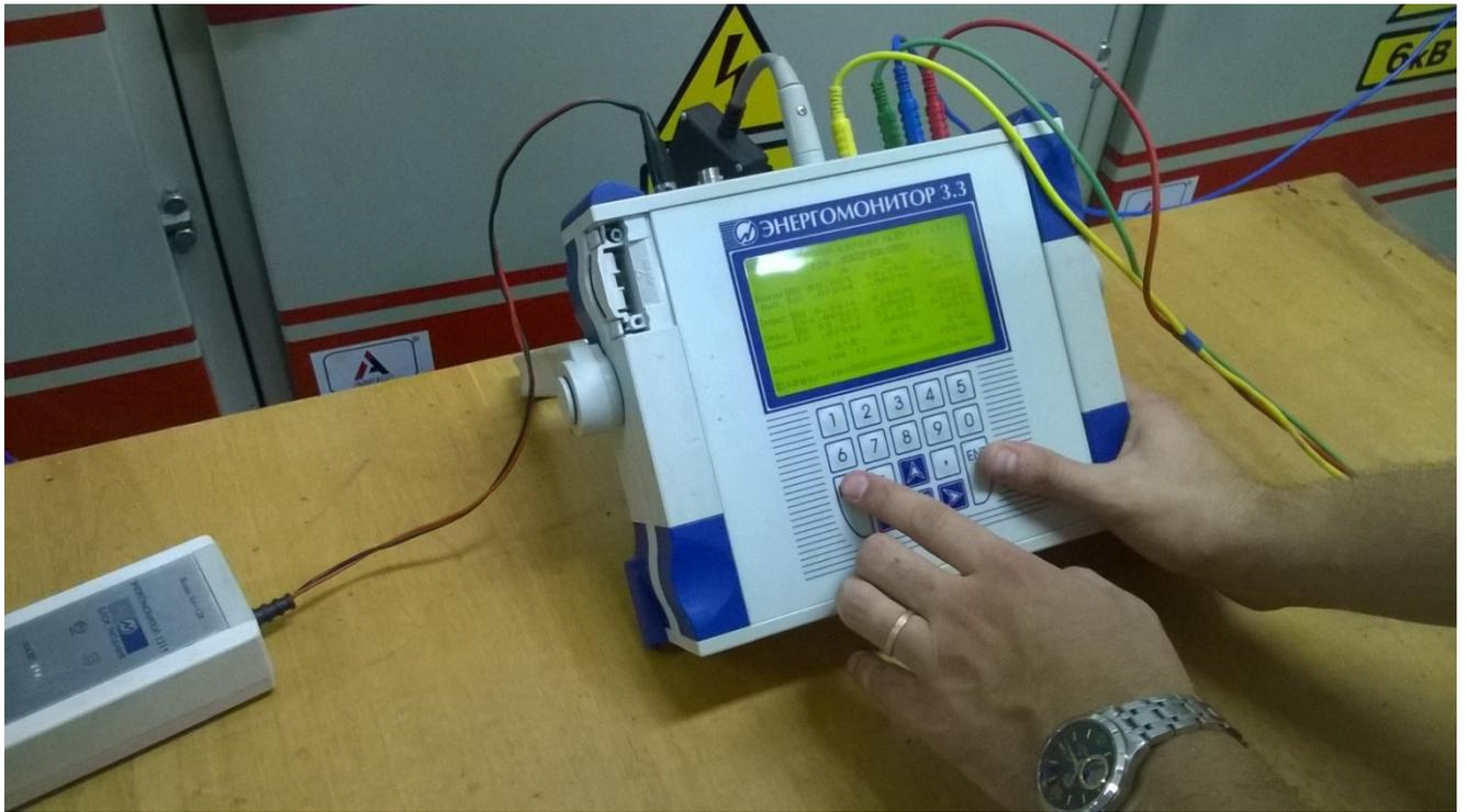
Рисунок 1. Установка и настройка прибора «Энергомонитор - 3.3Т1»
