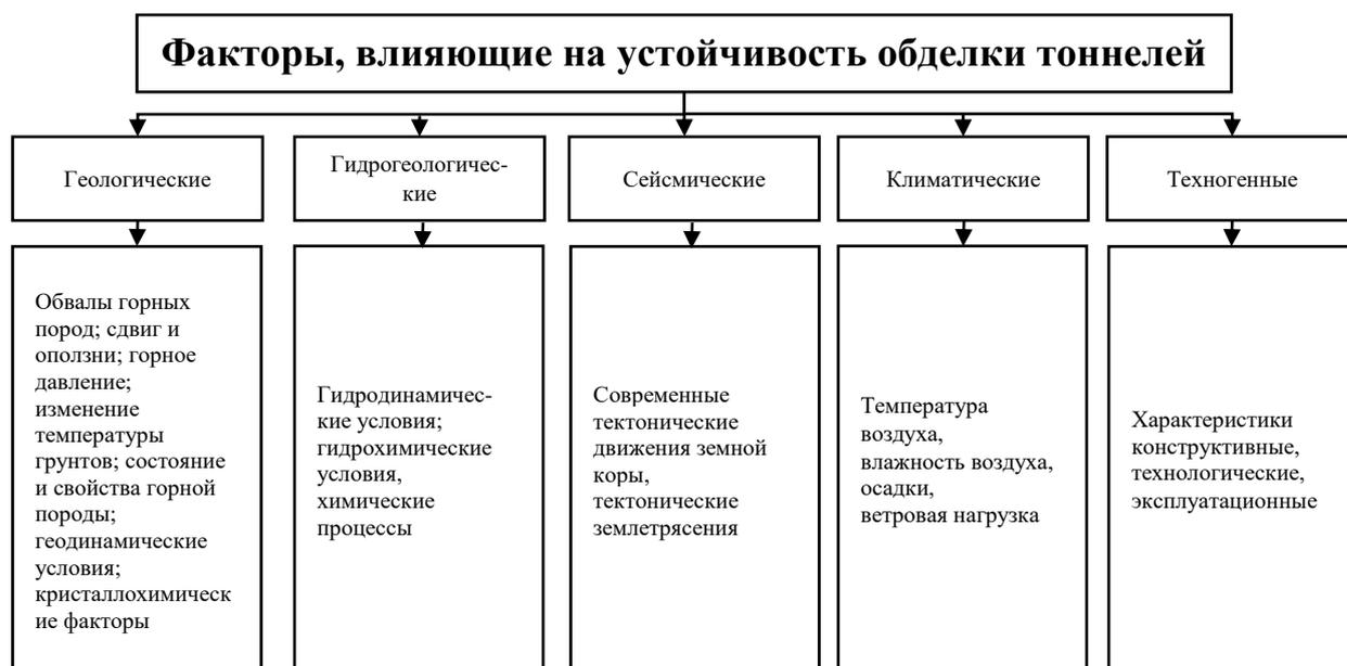
Рисунок 1.1 – Систематизация факторов, влияющих на устойчивость обделки тоннелей
