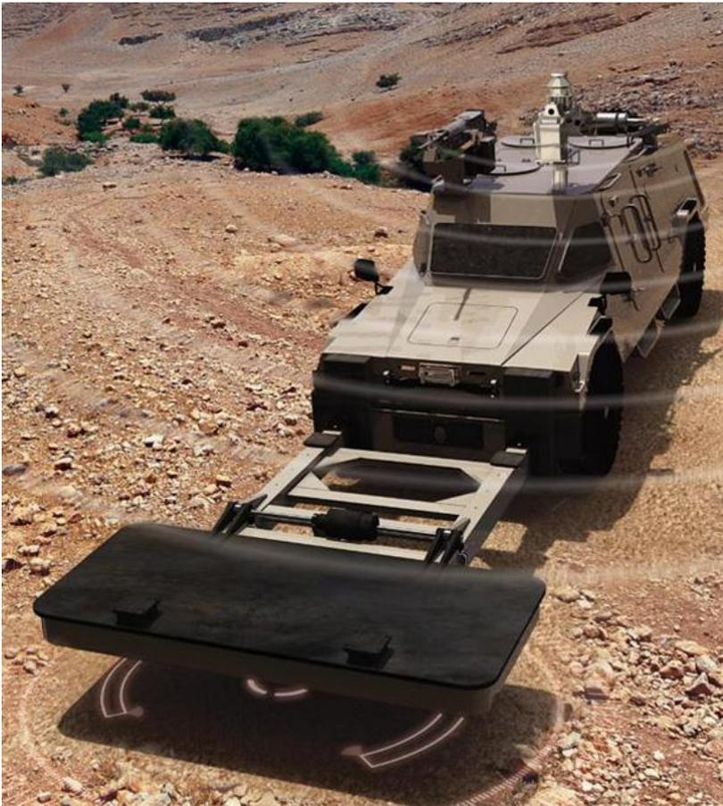
Рис. 1.16. Концепт мобильного поискового комплекса с использованием георадара, инфракрасного спектрометра и нелинейного радара (Израиль)
