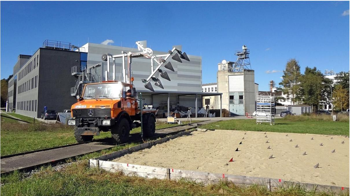
Рис. 1.9. Экспериментальная разработка подповерхностного радиолокатора, German Aerospace Centre (ФРГ)
