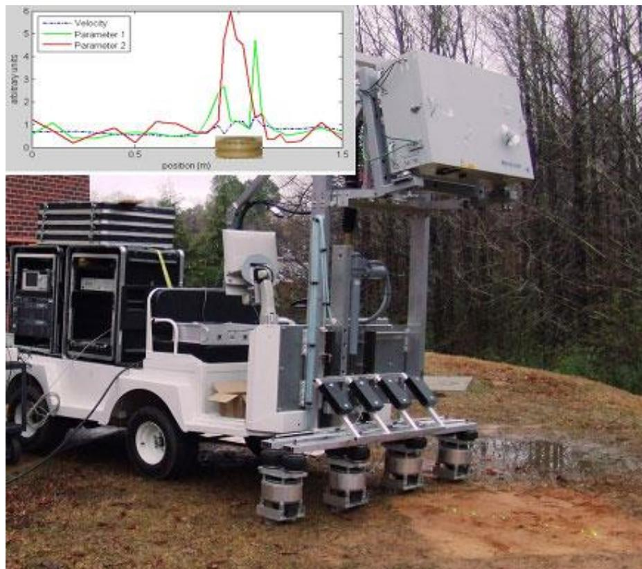
Рис. 1.15. Экспериментальная установка на основе воздушных акустических излучателей и лазерного виброметра (США)
