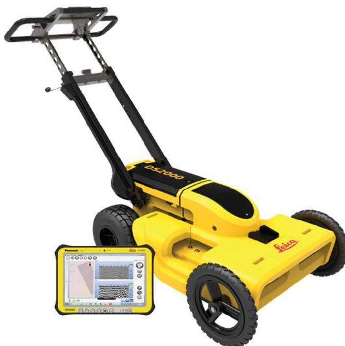
Рис. 1.10. Один из промышленных георадаров используемых в качестве поиска инженерных коммуникации
