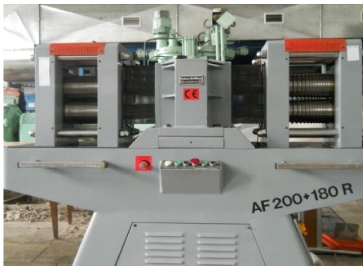
Рисунок 3.1 – Общий вид сортопрокатного стана
