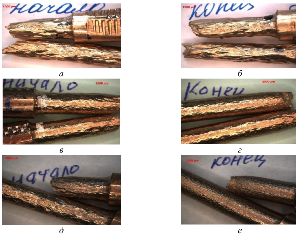
Рисунок 4.2 – Вид литых образцов опытно-промышленной плавки после испытаний на растяжение: а, б – сплав ЗлНЦМ 585-12,5-4; в, з – сплав № 1; д, е – сплав № 2
