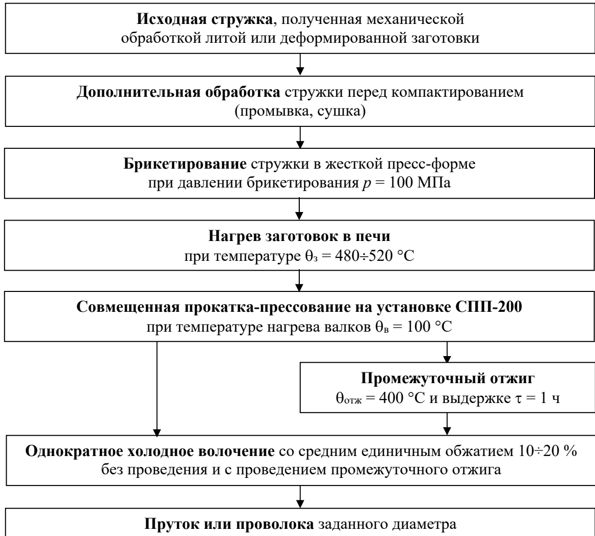
Рисунок 3.1 – Технологическая схема получения деформированных полуфабрикатов с помощью метода непрерывного прессования
