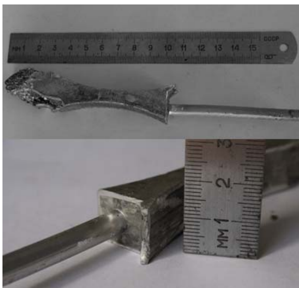
Рисунок 3.16 – Формоизменение металла при совмещенной прокатке-прессовании
