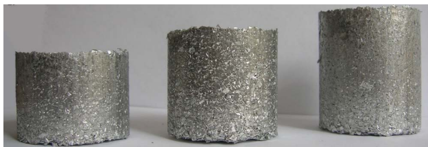
Рисунок 2.5 – Внешний вид полученных при давлении p_{бр} = 200 МПа брикетов в зависимости от массы засыпаемой стружки
