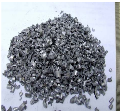
Рисунок 2.14 – Общий вид стружки сплава АК12, используемой в работе
