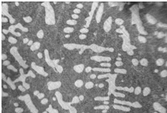
Рисунок 4.21 – Микроструктура колеса из сплава АК12 модифицированного лигатурами AlSr ( a ) и AlSr + AlTiB ( б ), \times 200
