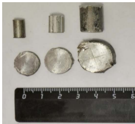
Рисунок 2.10 – Вид образцов прутков разного диаметра до и после испытания на сжатие
