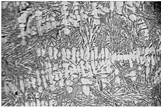
Рисунок 4.20 – Микроструктура колес из сплава АК12 до ( a ) и после ( б ) введения проволоочной лигатуры диаметром 4,2 мм из стружковых отходов, \times 200
