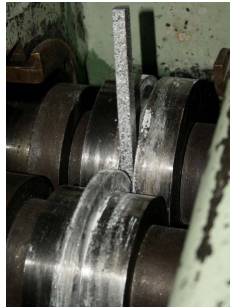
Рисунок 3.14 – Общий вид скомпактированных брикетов из стружки ( a ) и их подача в валки установки СПП-200 ( б )
