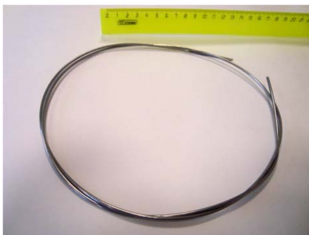
Рисунок 4.22 – Проволока диаметром 2,0 мм, изготовленная из стружки сплава АК12
