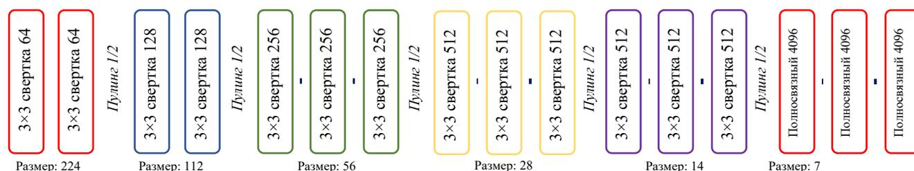
Рисунок 11 – Архитектура СНС VGG-16
