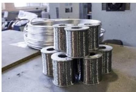
Рисунок 4.11. Опытные партии проволоки диаметром 0,5 мм из сплава 01417 в катушках
