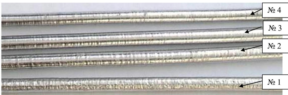
Рисунок 3.1 – Непрерывнолитые прутки из сплава 01417 диаметром 12 мм, полученные в ЭМК с различной скоростью литья: 1 – 14,5 мм/с, 2– 10,8 мм/с, 3 – 7,4 мм/с, 4 – 4,4 мм/с
