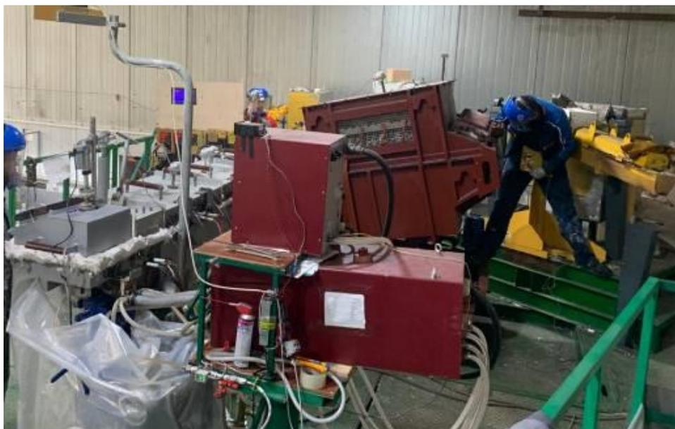
Рисунок 1.4 - Опытно-промышленная установка непрерывного литья в электромагнитный кристаллизатор
