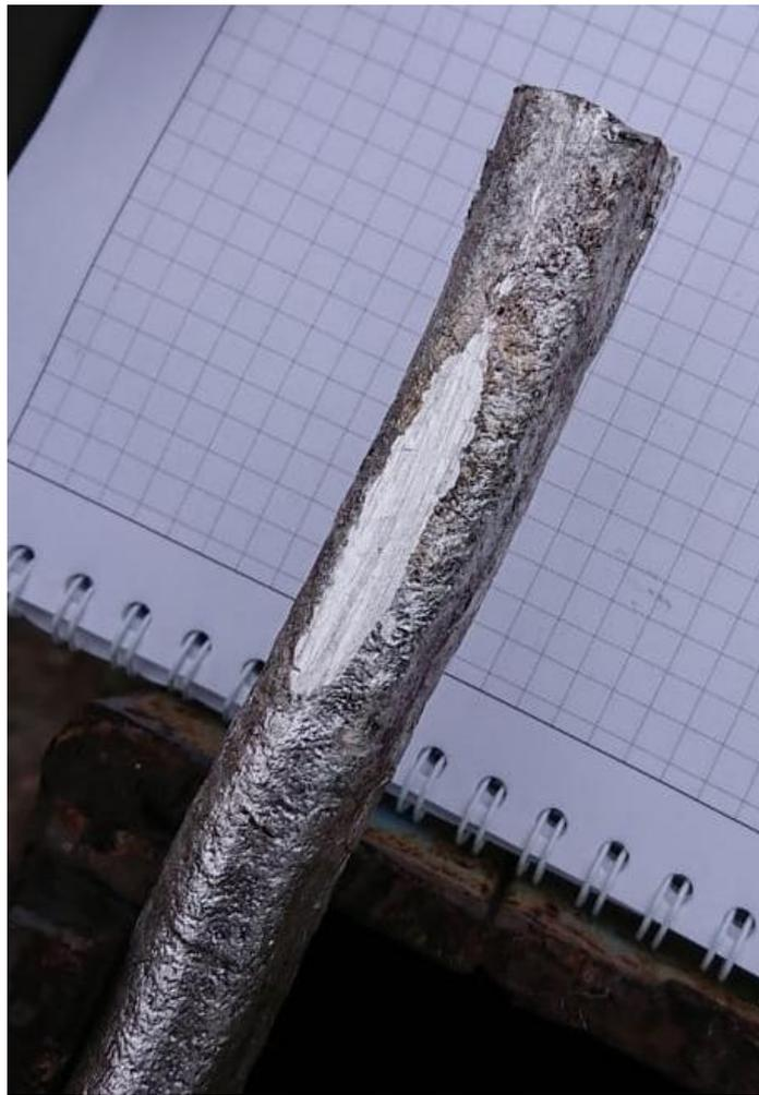
Рисунок 2.7 – Круглая заготовка после прокатки-прессования в ящичном калибре
