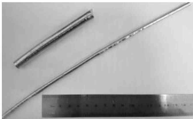
Рисунок 3.4 - Экспериментальные образцы прутков диаметром 4 и 9,5 мм
