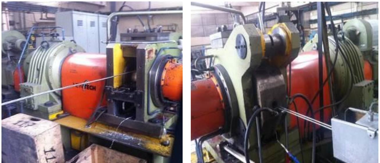
Рисунок 4.2 – Промышленная установка Конформ TLJ 300
