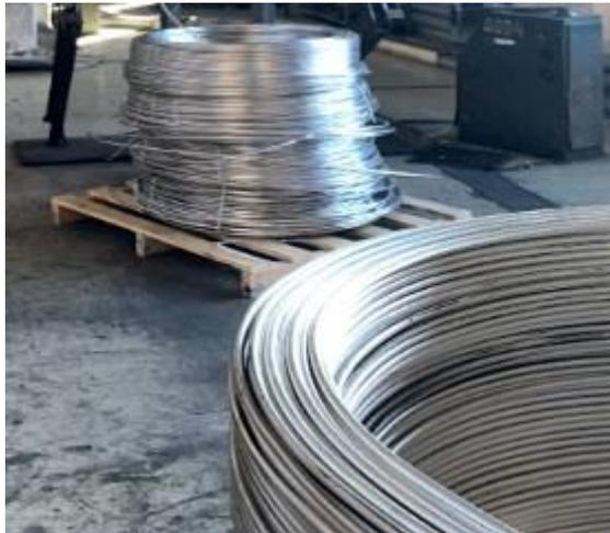
Рисунок 4.1 - Опытная бухта непрерывнолитой заготовки из сплава 01417, отлитая методом ЭМК
