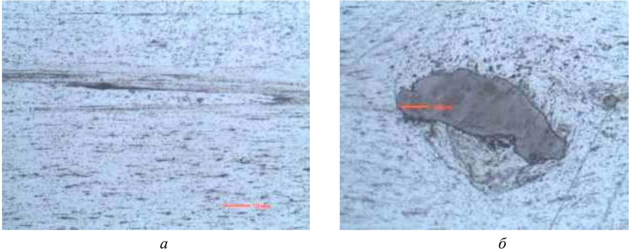
Рисунок 3.12 - Микроструктура образца поперечным сечением 5 мм, полученного на установке Конформ с микронесплошностями (а) и включениями (б), x1000
