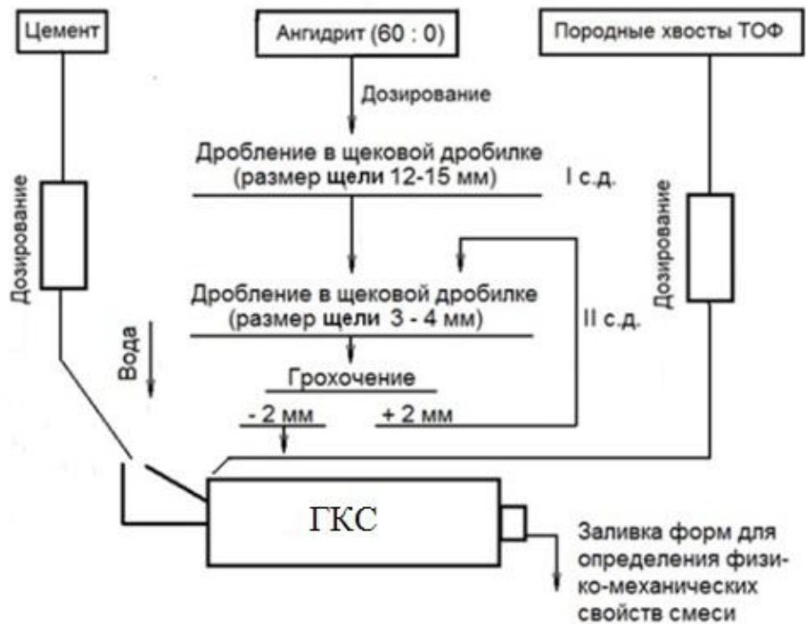
Рисунок 3.9 - Схема приготовления твердеющей смеси АХЦ в лабораторных условиях с использованием ГКС
