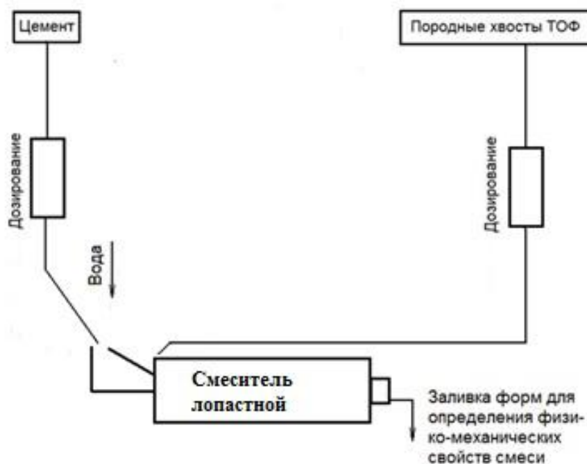
Рисунок 2.3 - Схема приготовления твердеющей смеси ХЦ в лабораторных условиях с использованием лопастного смесителя
