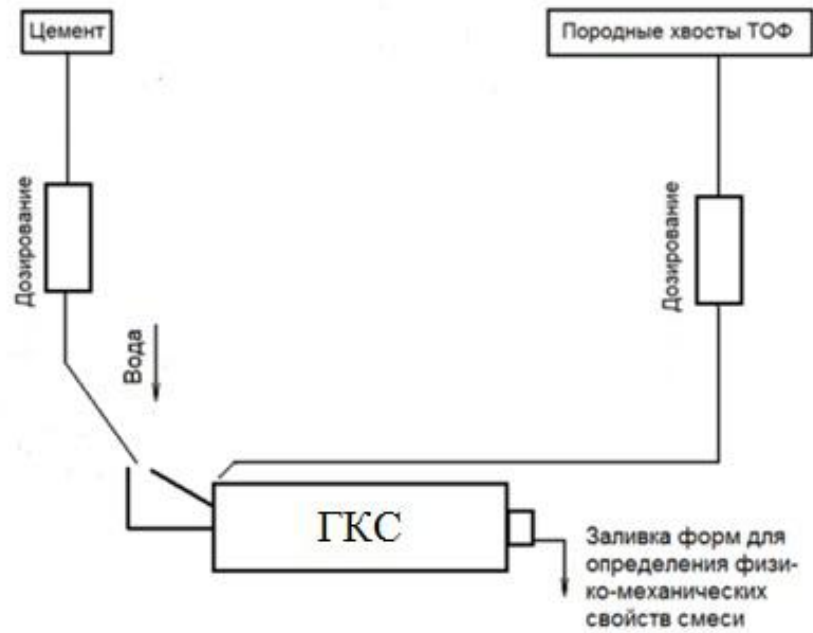
Рисунок 3.8- Схема приготовления твердеющей смеси ХЦ в лабораторных условиях с использованием ГКС
