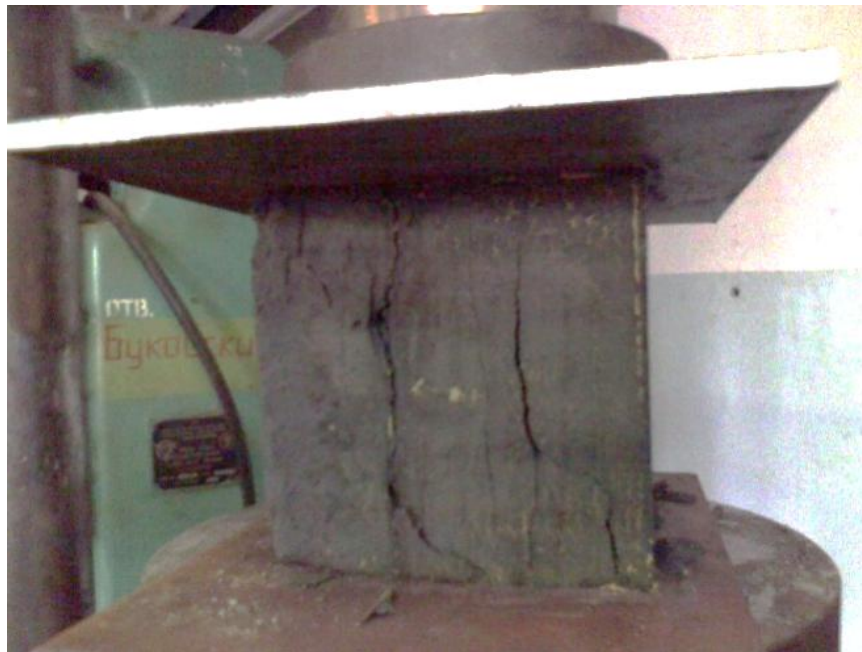
Рисунок 2.15 - Испытание образцов на прочность составов АХЦ с использованием лопастного смесителя
