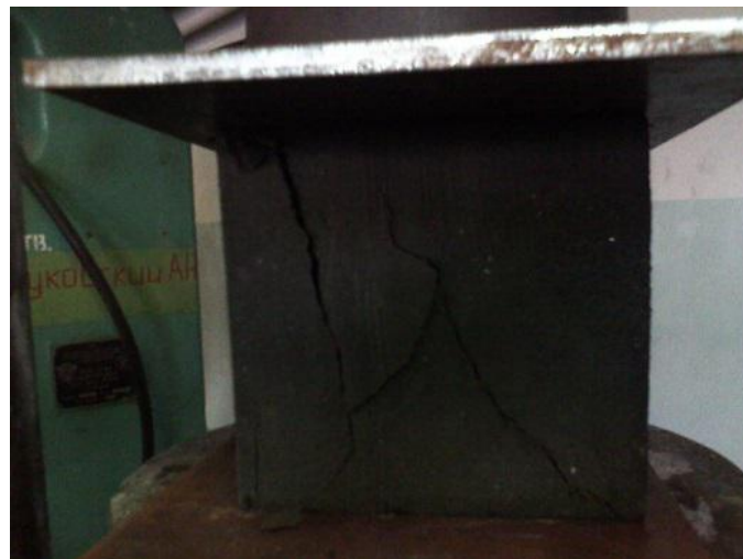
Рисунок 3.12 - Испытание образцов на прочность составов ХЦ с применением ГКС
