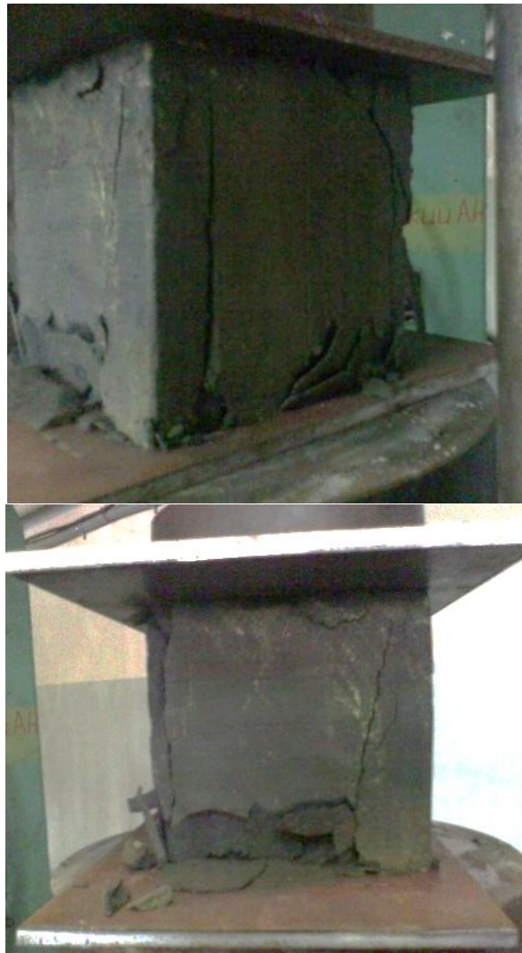
Рисунок 2.18 - Испытание образцов на прочность составов АХЦ с использованием шаровой мельницы
