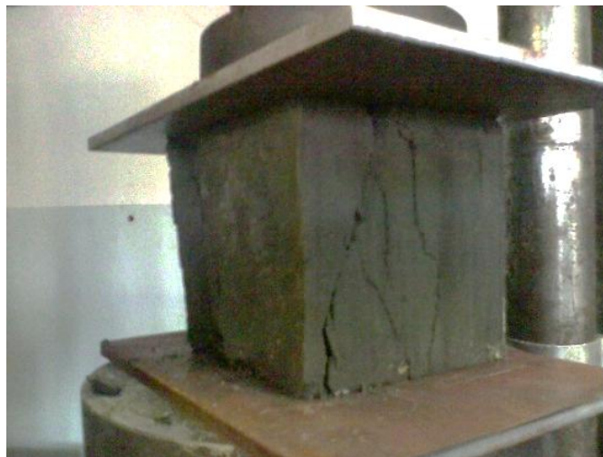
Рисунок 2.11- Испытание образцов на прочность составов ХЦ с использованием шаровой мельницы
