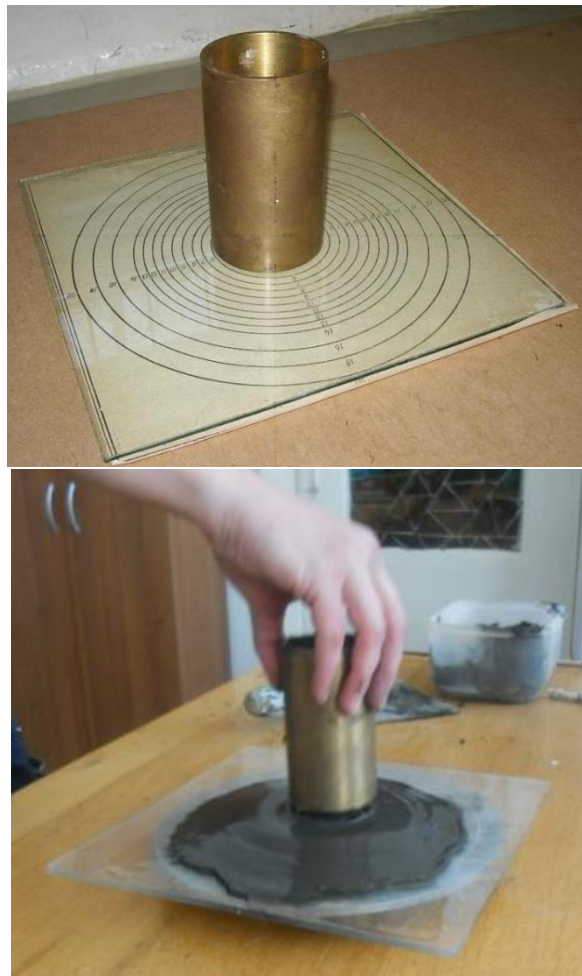
Рисунок 2.4 - Определение растекаемости закладочной смеси (вискозиметр Суттарда)
