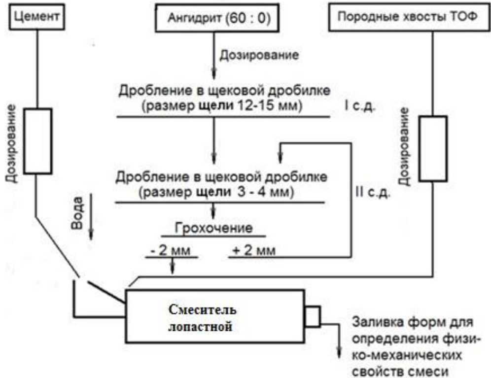
Рисунок 2.12 - Схема приготовления твердеющей смеси АХЦ в лабораторных условиях с использованием лопастного смесителя
