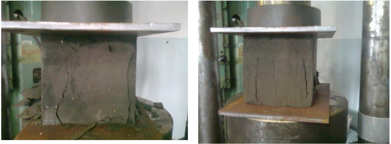
Рисунок 2.6- Испытание образцов на прочность составов ХЦ с использованием лопастного смесителя
