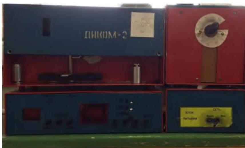
Рисунок 2.6 – Малообъемный вискозиметр
