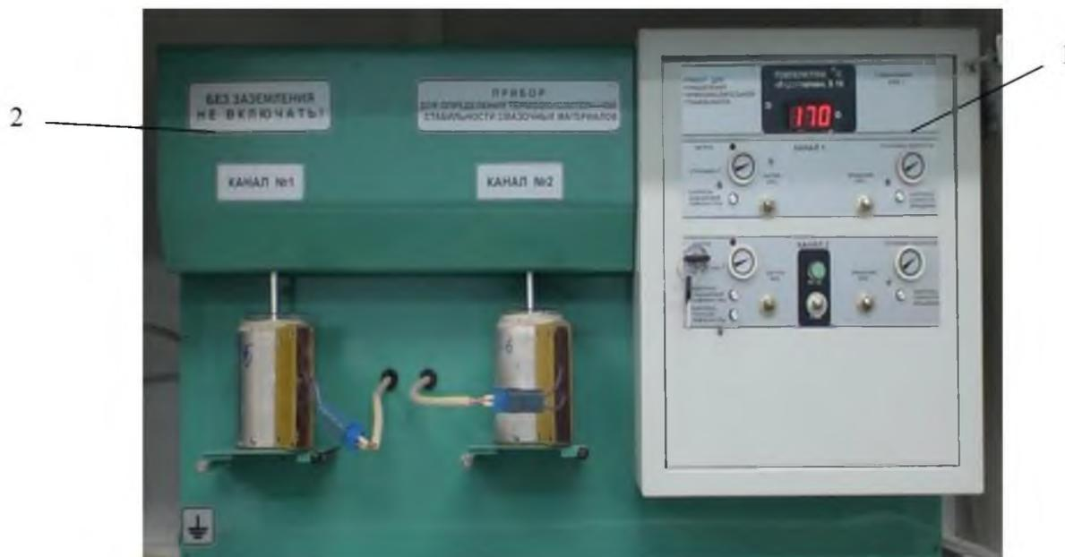
Рисунок 2.1 – Общий вид прибора для определения термоокислительной стабильности смазочных масел: 1 – блок измерения и управления; 2 – механический блок
