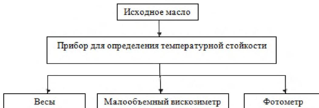
Рисунок 4.2 – Схема комплексного метода контроля температурной стойкости моторных масел различной базовой основы
