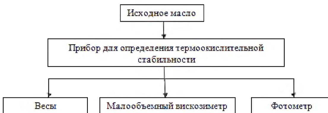
Рисунок 4.1 – Схема метода контроля термоокислительной стабильности моторных масел различной базовой основы
