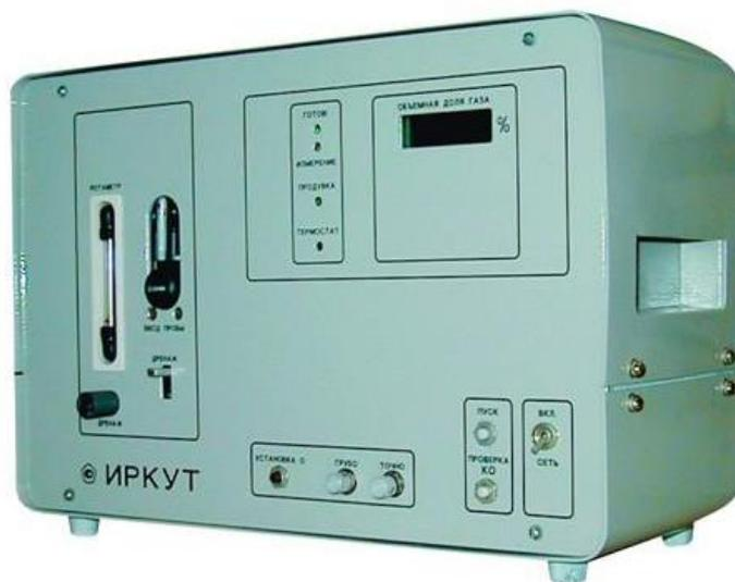
Рисунок 4.13 – Прибор для определения газосодержания в жидкости ИРКУТ
