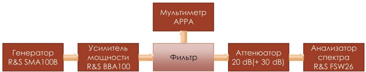
Рисунок 3.40 – Схема измерений при проверке работоспособности фильтров при сигналах повышенной мощности
