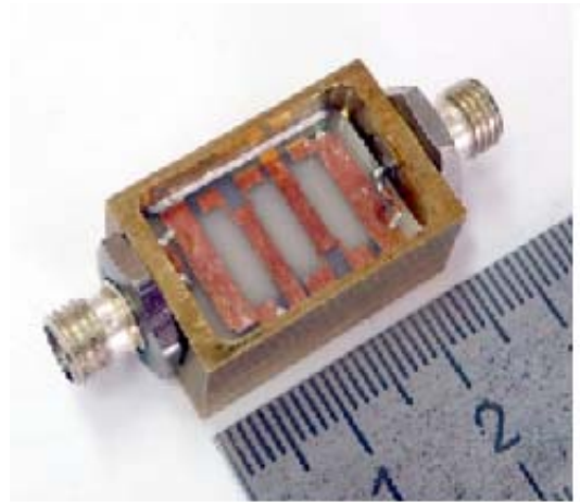
Рисунок 2.43 – Топология проводников и фотография изготовленного четырехзвенного фильтра с дополнительной емкостной связью
