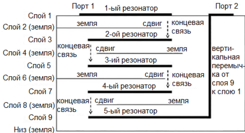
Рисунок 1.30 – Схема многослойного фильтра с концевыми связями резонаторов [132]
