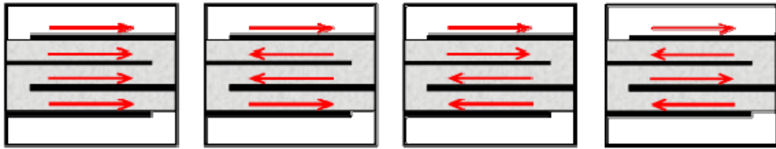
Рисунок 2.25 – Распределение высокочастотных токов вдоль проводников четырехпроводникового резонатора на разных модах
