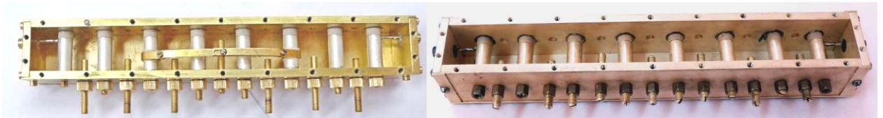
Рисунок 1.18 – Макеты фильтров восьмого порядка с дополнительной емкостной связью (слева) и без нее (справа) [34]
