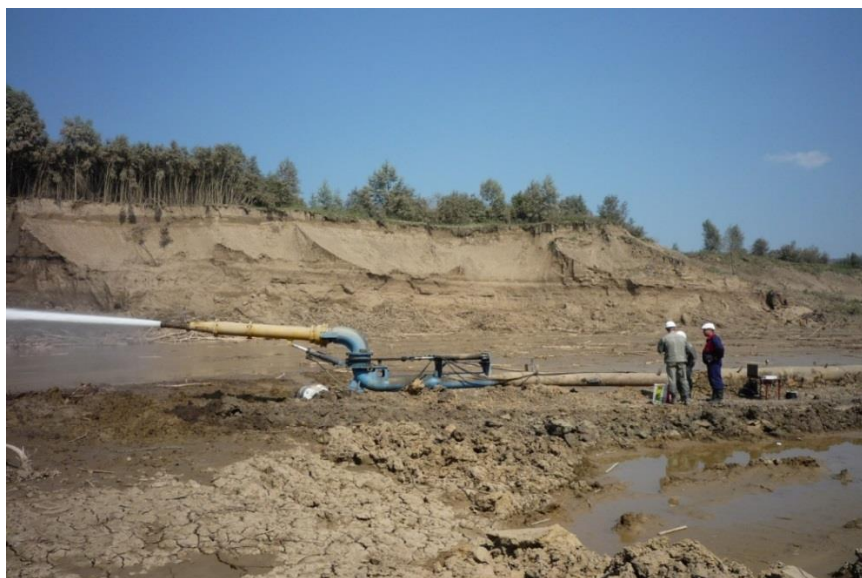
Рисунок 1.4 – Гидромонитор ГД-300, размывающий вскрышные породы, уложенные в гидроотвал № 3 разреза «Кедровский»
