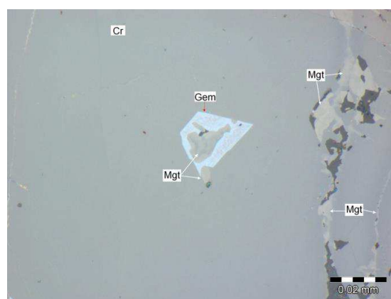
Рисунок 4.4 – Замещение магнетитового агрегата метакристаллом гематита. Анш. МЛ-2
