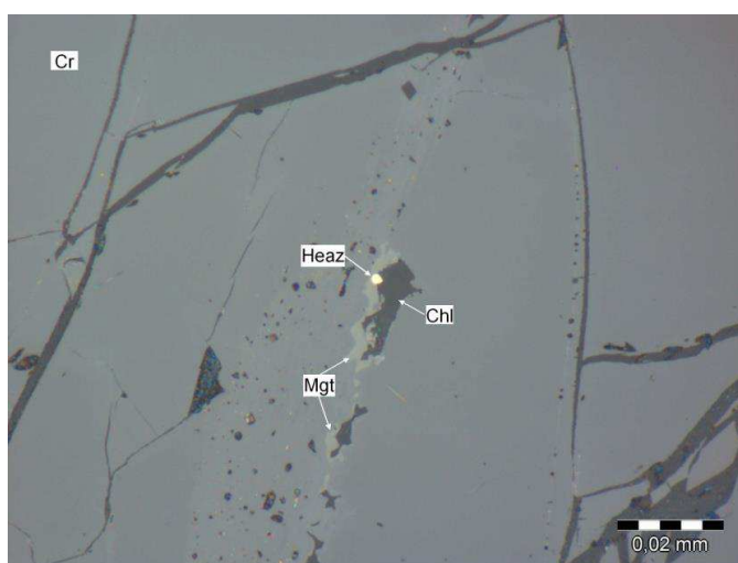
Рисунок 4.9 – Кристалл хизлевудита на краю включения хлорита. Отраженный свет. Анш. С-2
