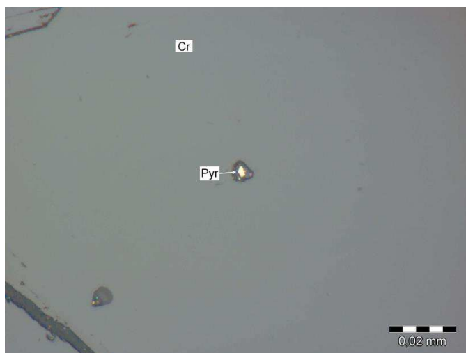
Рисунок 4.11 – Мелкое включение пирита в хромите. Отраженный свет. Анш. Г-1-2
