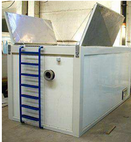
Рисунок 3 – Установка очистки нефтесодержащих сточных вод
