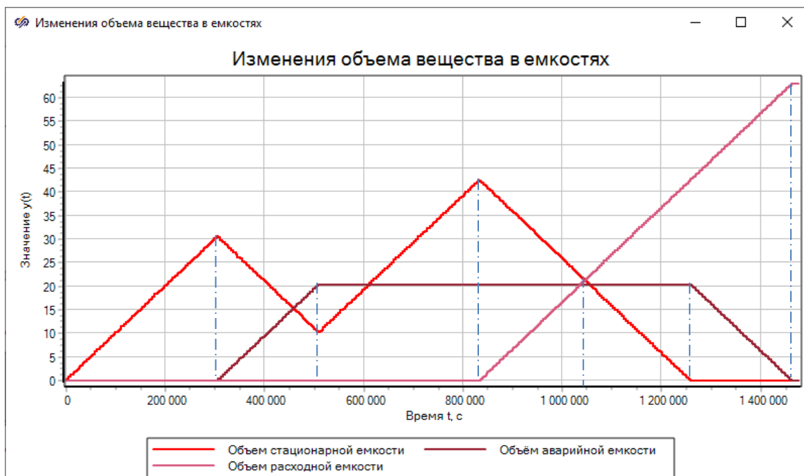
Рисунок 59 – Изменение объема бутанола в емкостях с участием аварии
