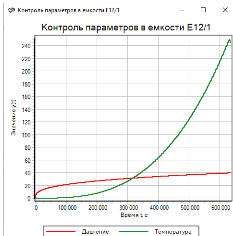
Рисунок 45 – Графики давления и температуры при заполненной стационарной емкости
