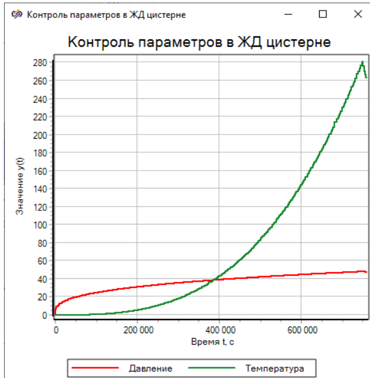
Рисунок 68 – Графики давления и температуры при заполненной ЖД цистерне
