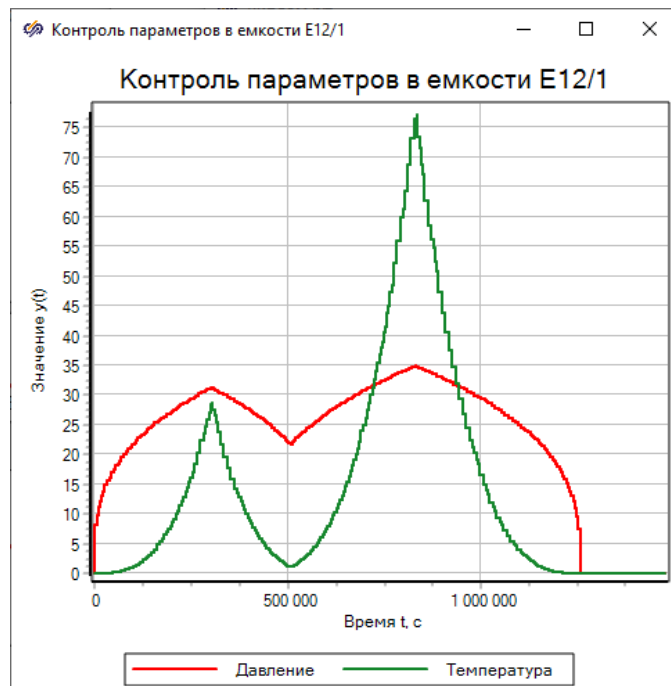
Рисунок 60 – Контрольные параметры стационарной емкости при включении аварии
