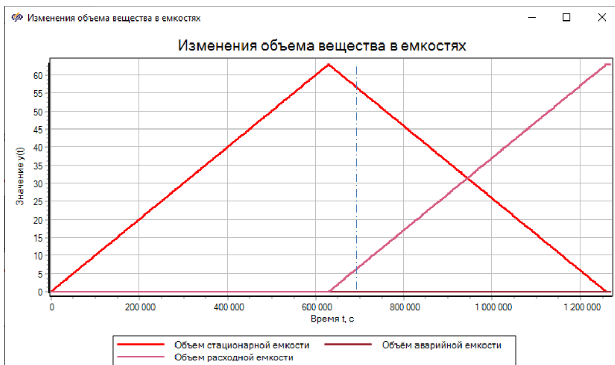
Рисунок 50 – Изменения объема бутанола в емкостях при автоматическом переливании
