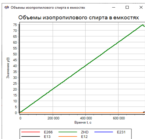
Рисунок 67 – Изменение объема изопропанола в ЖД цистерне
