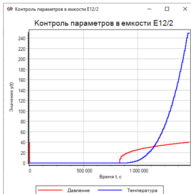
Рисунок 61 – Контрольные параметры расходной емкости при включении аварии
