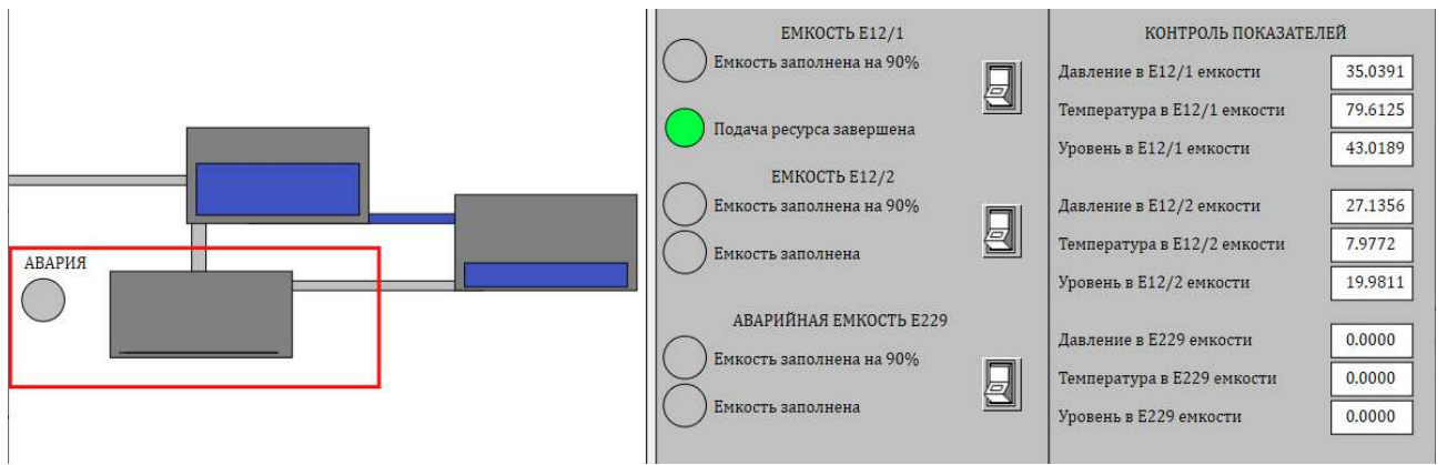
Рисунок 47 – Автоматическое переливание бутанола из стационарной в расходную емкость после полного наполнения первой
