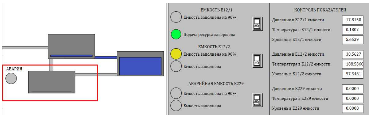
Рисунок 48 – Индикация заполнения расходной емкости на 90 %
