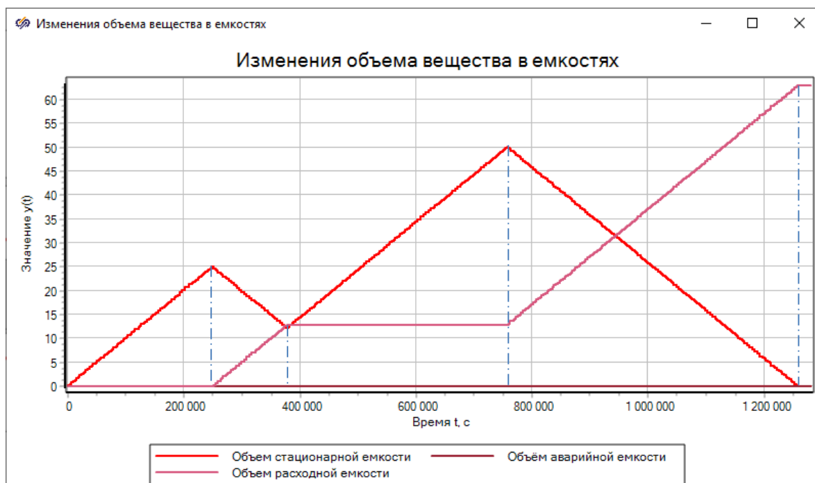
Рисунок 54 – Изменение объема бутанола в емкостях с участием ручного включения переливания
