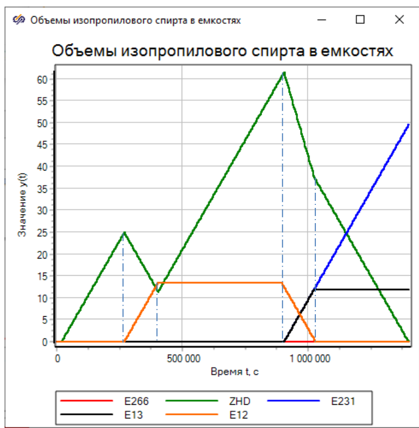
Рисунок 80 – Объемы изопропилового спирта в емкостях при включении аварии
