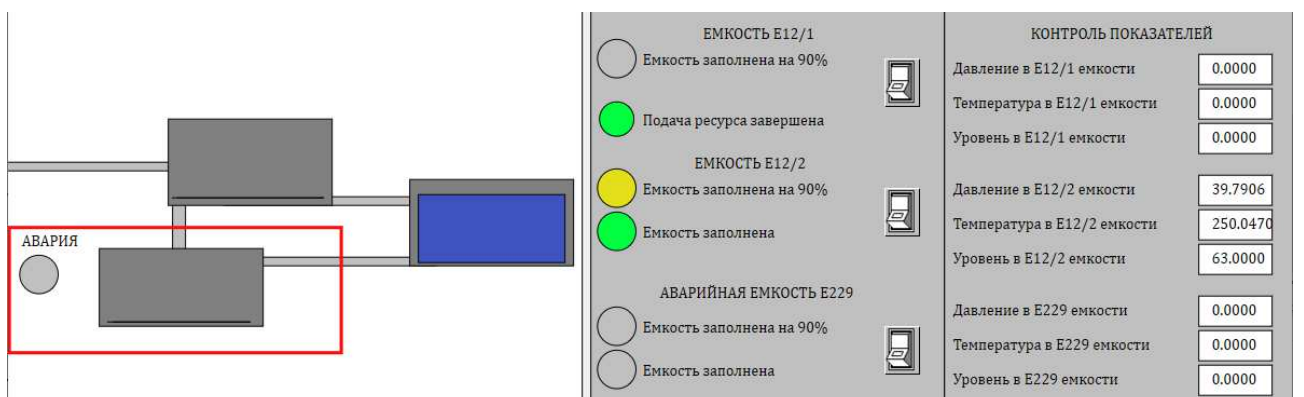
Рисунок 49 – Индикация полностью заполненной расходной емкости
