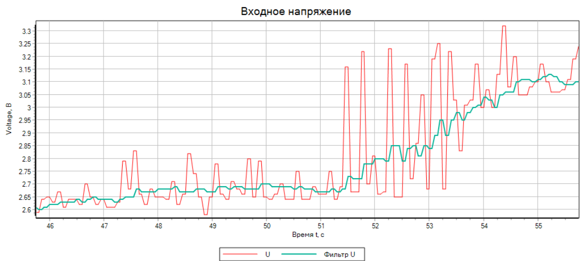
Рисунок 28 – График реального и отфильтрованного входного напряжения
