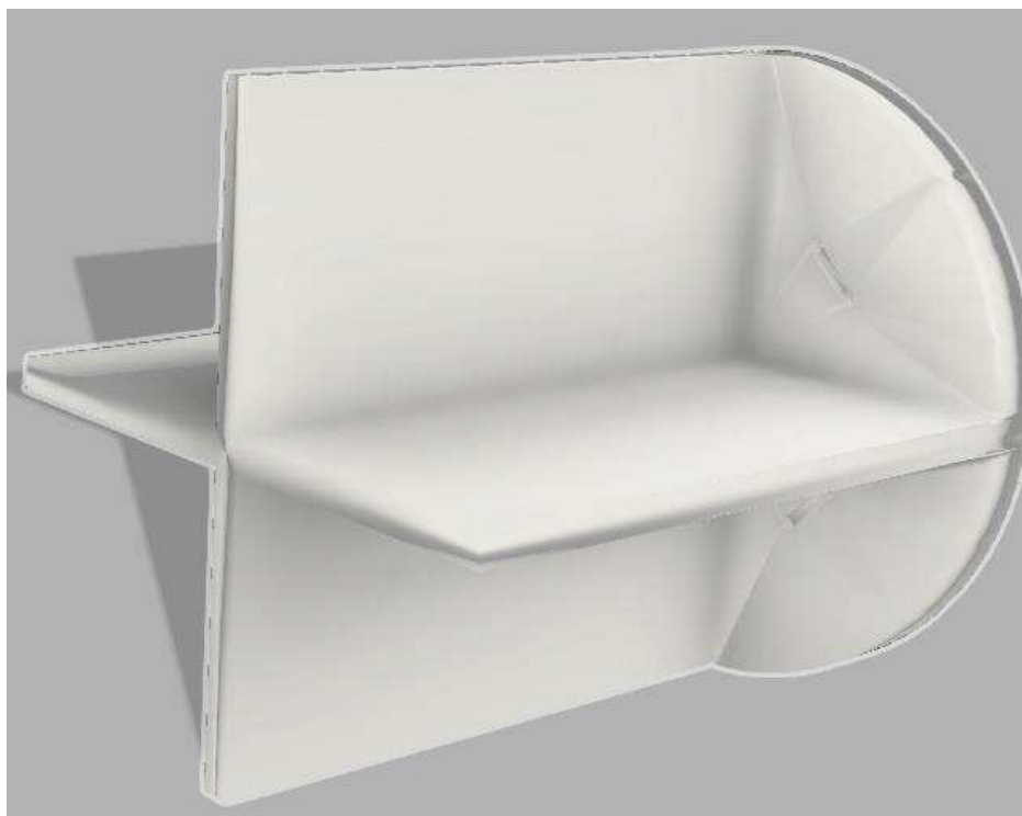
Рисунок 3 – Пример детали для установки светочувствительных модулей
