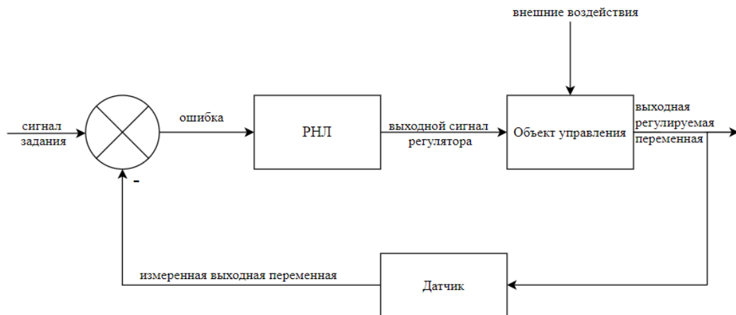
Рисунок 5 - Структурная схема замкнутой системы с регулятором с нечеткой логикой
