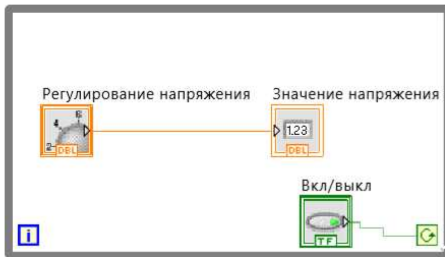
Рисунок 32 – Виртуальное управление механической нагрузкой (Block Diagram)
