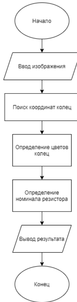
Рисунок 2.22 – Алгоритм определения номинала резистора
