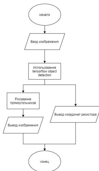
Рисунок 2.20 – Алгоритм определения местоположения резистора
