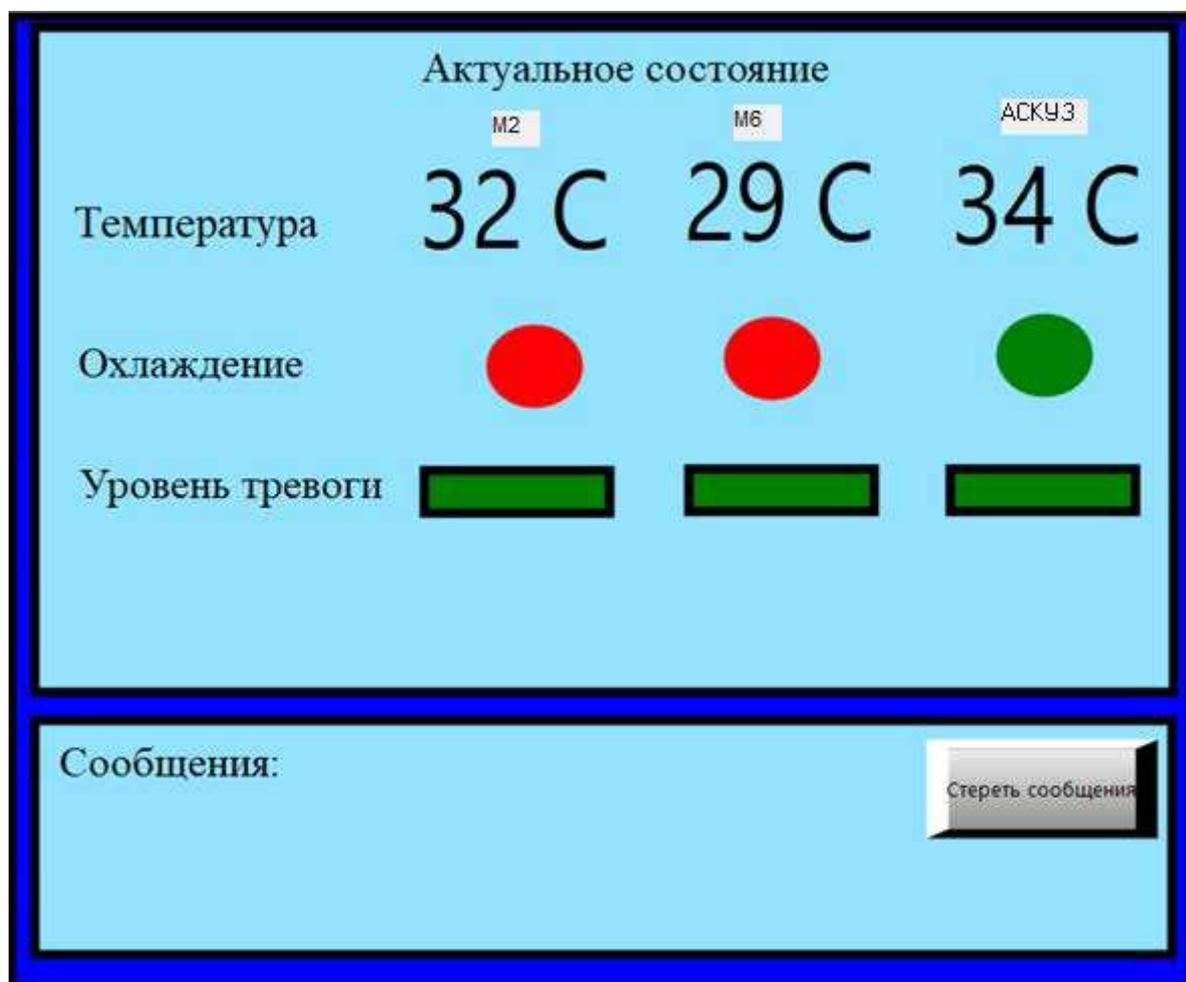
Рисунок 19 – Разработанный интерфейс SCADA-системы на рабочем ПК специалиста
