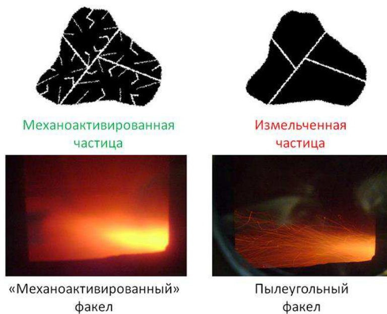
Рисунок 1.6 – Горение механоактивированной угольной пыли
