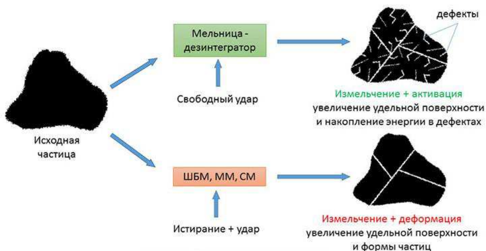
Рисунок 1.5 – Механоактивация угля в дезинтеграторе
