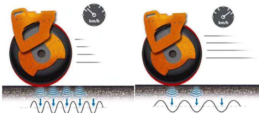
Рисунок 6 – Распределение ударных импульсов при движении катка
