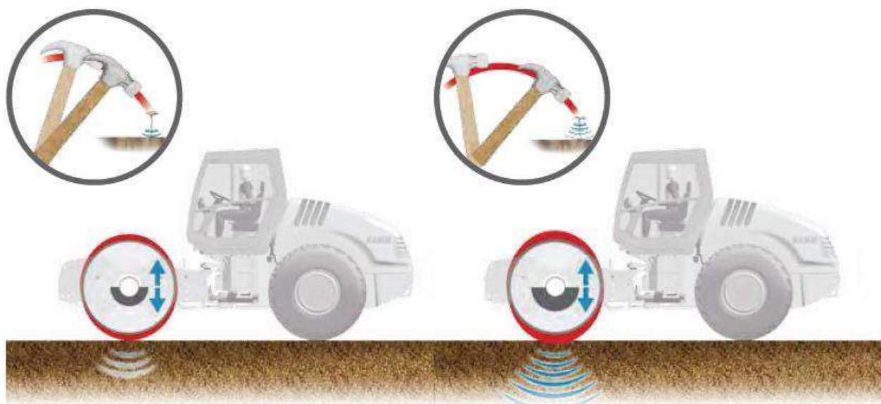
Рисунок 5 – Воздействие вальца на уплотняемую поверхность
