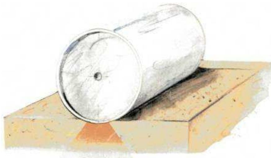
Рисунок 1 – Влияние статического вала катка на материал при его уплотнении
