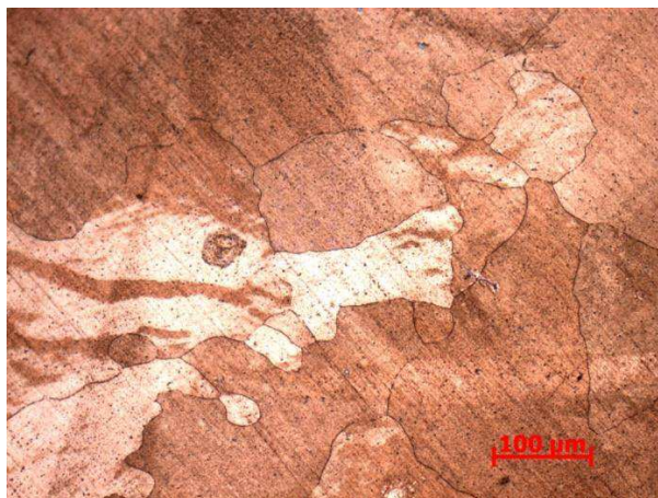
Рисунок 3.2 – Микроструктура образца дисперсно-упрочненного сплава, модифицированного кадмием (0,1 %) и микролегированного РЗМ (0,1 %)
