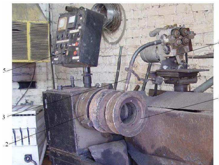
Рисунок 5.4 – Наплавка опорного катка гусеничного бульдозера порошковой проволокой на установке УД-209: 1 – каток; 2 – зажимной патрон; 3 – горелка; 4 – подающий механизм; 5 – пульт управления
