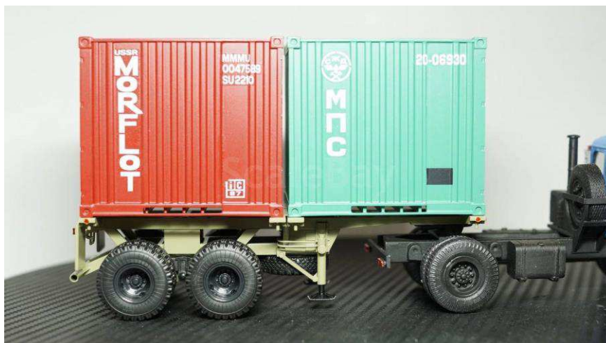
Рисунок 30 – Полуприцеп ЧМЗАП-9985 с двумя контейнерами
