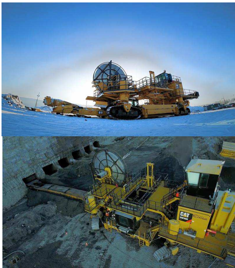
Рисунок 18 – Комплекс КГРП Caterpillar HW300
