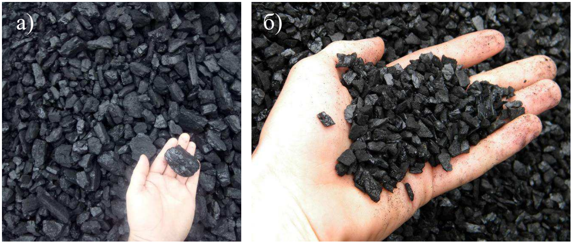
а – размер «орех»; б – размер «семечка» Рисунок 23 – Сорта мелких фракций угля
