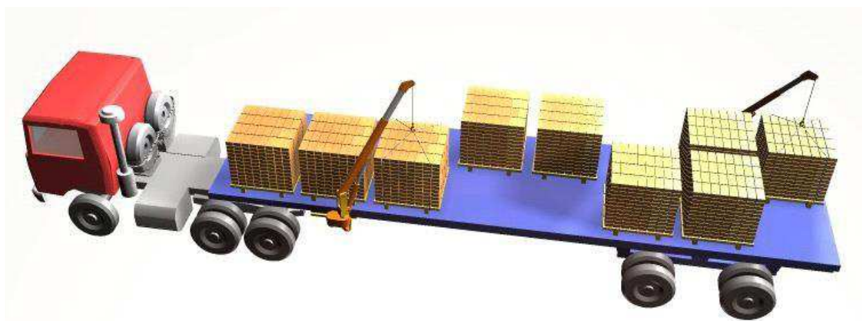
Рисунок 33 – Тягач с полуприцепом, используемый для перевозки малогабаритных и мягких контейнеров
