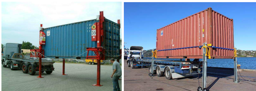
Рисунок 43 – Выгрузка контейнеров при помощи опускающихся стоек
