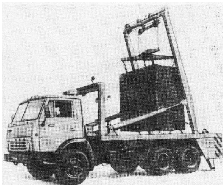
Рисунок 35 – Грузовой автомобиль-самопогрузчик на базе КамАЗа 5320 с краном портального типа
