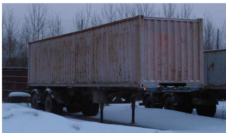
Рисунок 32 – Полуприцеп ЧМЗАП-99859 с двумя контейнерами
