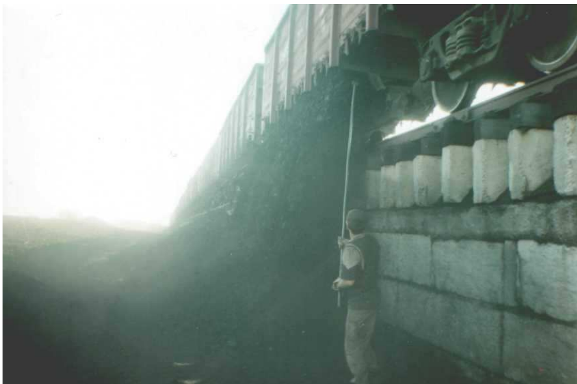
Рисунок 17 – Разгрузка угля из полувагонов на повышенном пути
