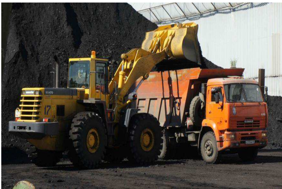
Рисунок 19 – Погрузка угля в автомашины одноковшовым погрузчиком на угольном складе ст. Бугач
