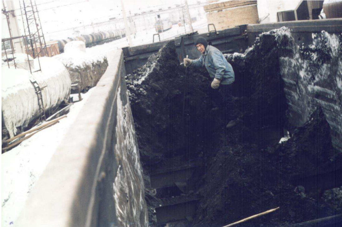
Рисунок 18 – Разгрузка смерзшегося угля из полувагона
