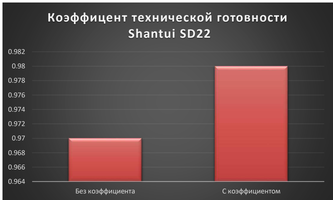
Рисунок 6 - Сравнение КТГ для бульдозера Shantui SD22
