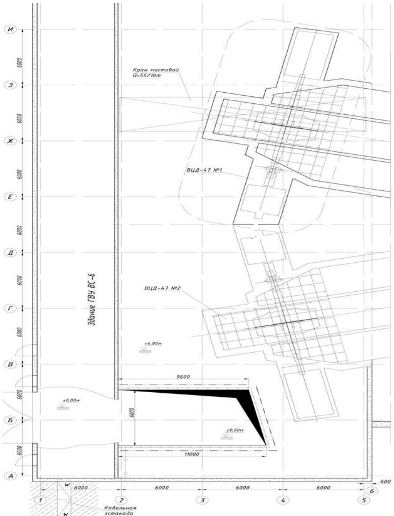
Рисунок 7 – Расположение вентиляторов ВЦД-47 в стволе ВС-6
