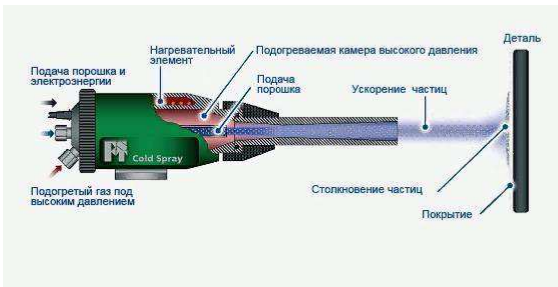
Рисунок 13 – Схема газодинамического напыления
