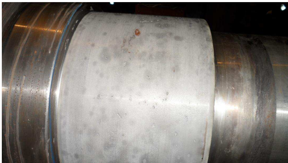
Рисунок 20 – Восстановленная шейка вала
