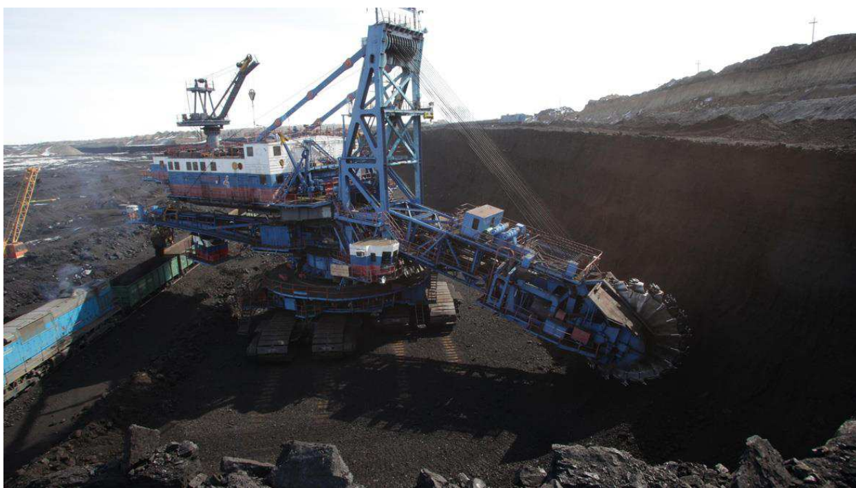
рис. 6.2 Экскаватор ЭР-2500 в забое.
