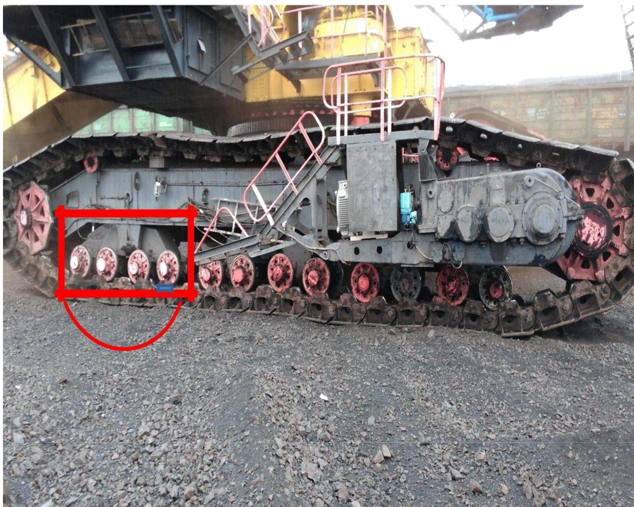
рис. 6.3 Место производства работ по замене балансира ходовог механизма
