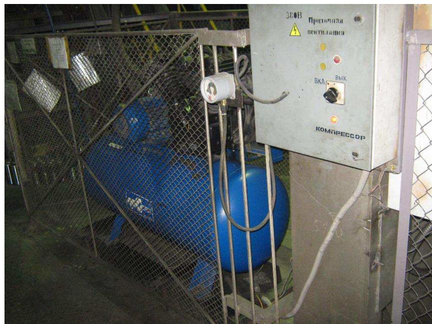
Рисунок 5.15 – Компрессор С416М1
