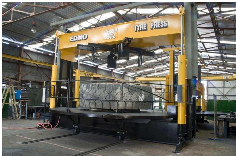
Рисунок 5.4 – Шинно монтажный пресс EDMO 175
