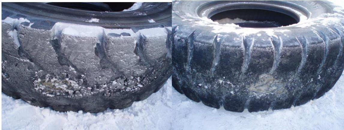
Рисунок 5.8 – Естественный износ рисунка протектора
