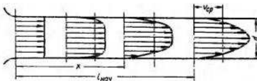
Рисунок 17 – Формирование профиля скоростей на начальном участке
