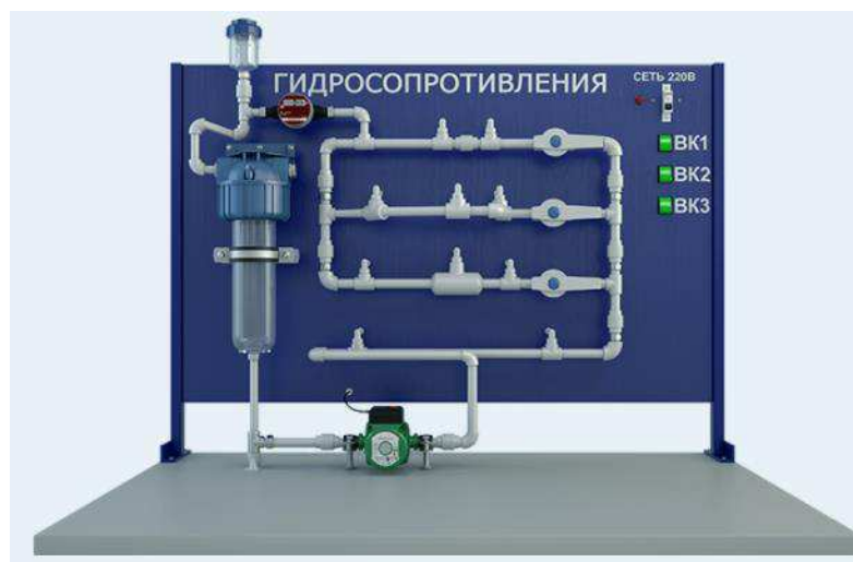
Рисунок 49 – Стенд по определению гидравлических сопротивлений фирмы «Measlab»
