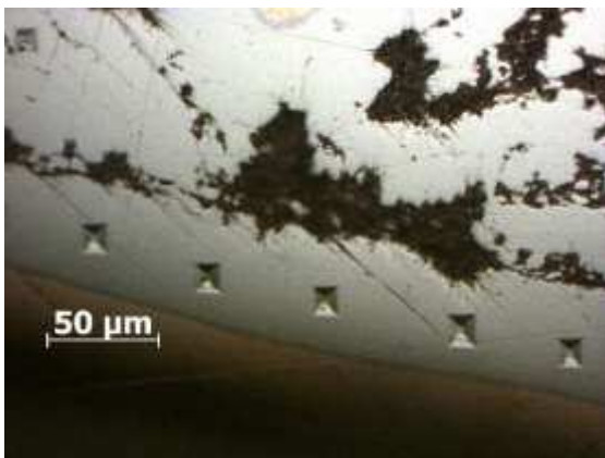
Рисунок 28 – Изображение отпечатков индентора на образце полученном при 140 °С и выдержке 10 часов ( а ) и распределение значений микротвердости на границе раздела фаз ( б )
