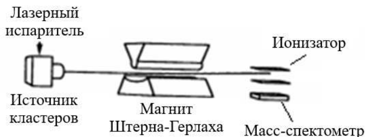
Рисунок 1.12 – Схема установки измерения отклонения кластерного пучка [44]
