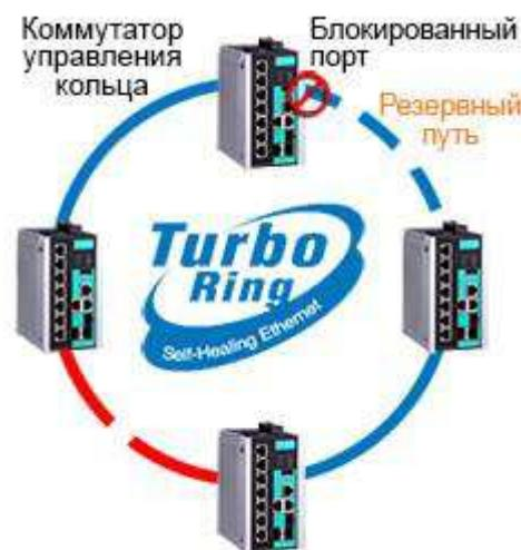
Рисунок 1- Топология сети Turbo Ring
