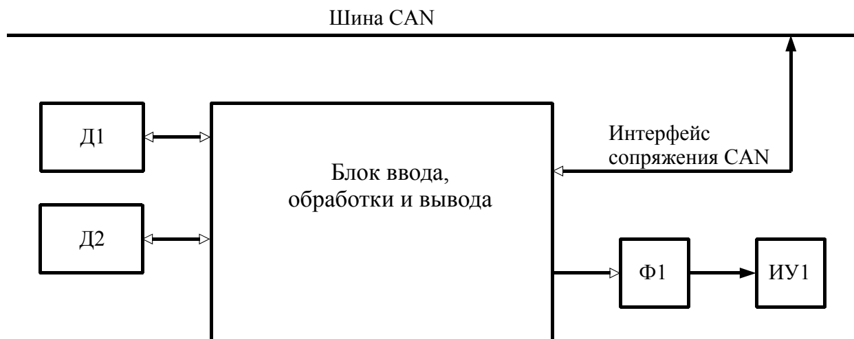
Рисунок 7 — Схема электрическая структурная блока нагрева воды в бассейне посредством солнечного теплового коллектора
