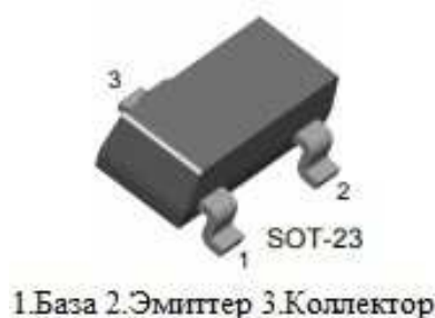
Рисунок 20 — Биполярный транзистор n-p-n BCX19LT1G в корпусе SOT-23
