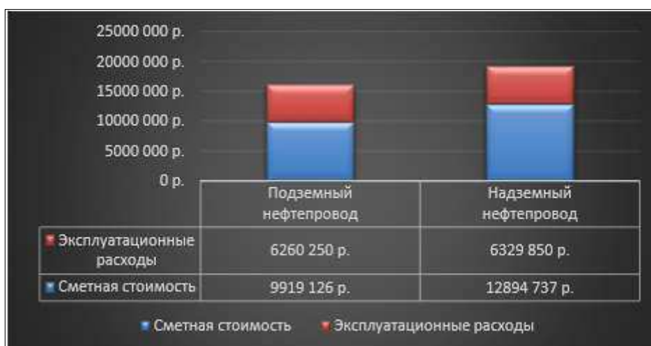
Рисунок 4. Сравнение затрат на сооружение и годовую эксплуатацию трубопровода при различных схемах прокладки
