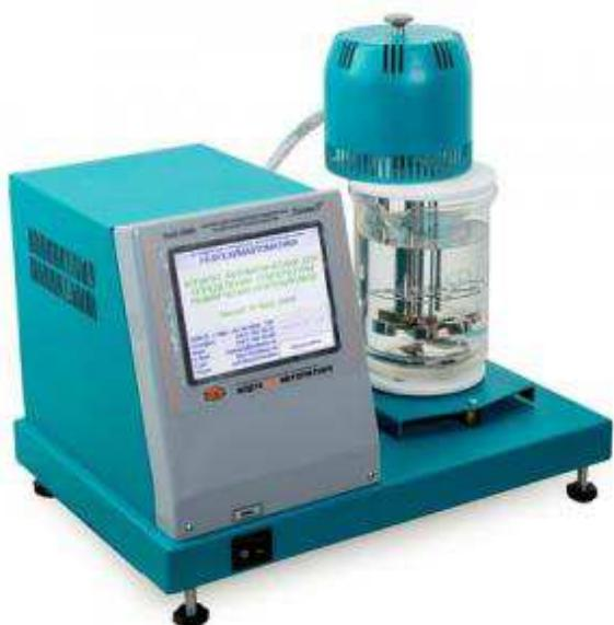
Рисунок 1.6 - Аппарат для определения температуры размягчения нефтебитумов
