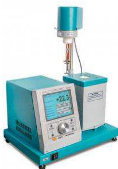
Рисунок 1.7 - Аппарат для определения температуры хрупкости нефтебитумов АТХ-20
