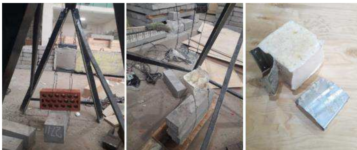
Рисунок 12б – Испытания на отрыв
