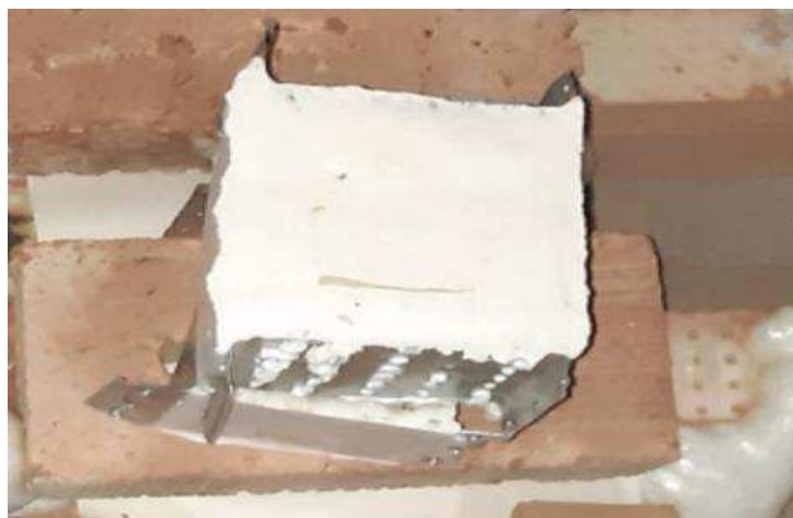
Рисунок 8 – Кубы 10x10x10 см из пенополиуретана, прикрепленного к стальному листу
