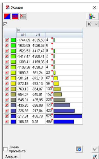
Рисунок 3.10 – продольные усилия от наиболее неблагоприятного сочетания загрузки.
