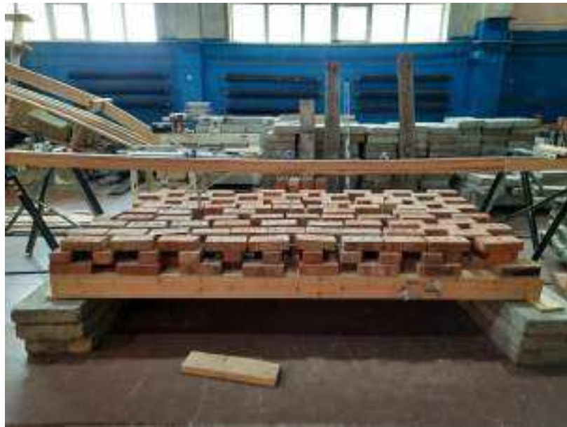
Рисунок 10.32 – Нагружение конструкции. Ступень 2. Вид 2
