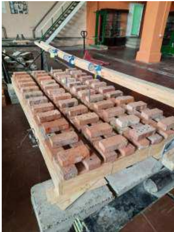
Рисунок 10.23 – Нагружение конструкции. Ступень 3. Вид 2
