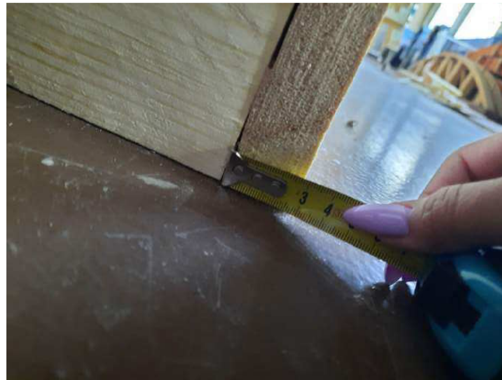
Измерение толщины продольных ребер (ребра 27 мм)
