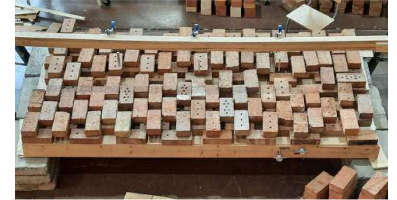
Вторая ступень нагружения: нагрузка 1,24 кПа
