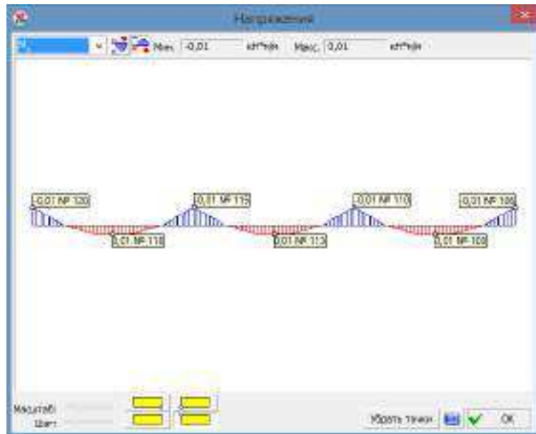
Рисунок 8.23 – Величины нормальных напряжений, \text{кН}\cdot\text{м}^2 при действии нагрузки, соответствующей 1 ступени нагружения (толщина ребер 45 мм)
