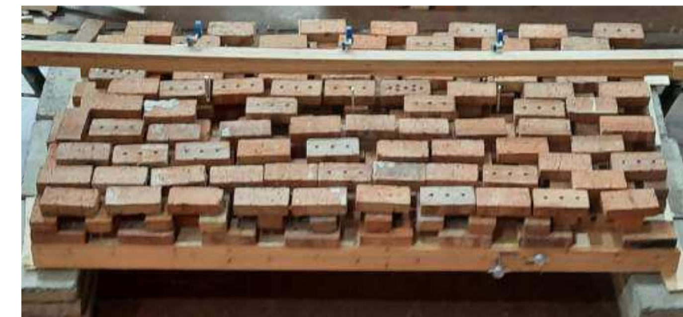
Третья ступень нагружения: нагрузка 1,85 кПа
