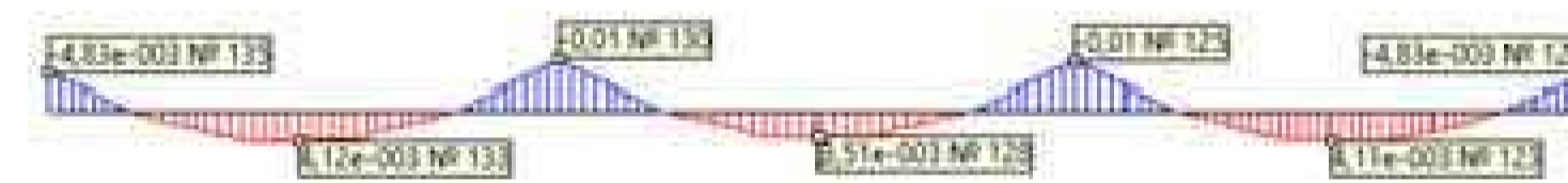
Эпюра изгибающих моментов в поперечном сечении клефанерной плиты на первой ступени нагружения (нагрузка 0,34 \text{ kH/m}^2 )
