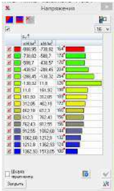
Рисунок 8.21 – Величины нормальных напряжений, кН/м 2 при действии нагрузки, соответствующей 3 ступени нагружения (толщина ребер 45 мм)
