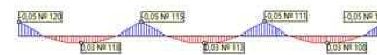
Эпюра изгибающих моментов в поперечном сечении клефанерной плиты на первой ступени нагружения (нагрузка 2,47 кН/м 2 )
