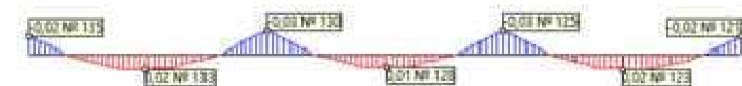
Эпюра изгибающих моментов в поперечном сечении клефанерной плиты на четвертой ступени нагружения (нагрузка 1,36 \text{ kH/m}^2 )
