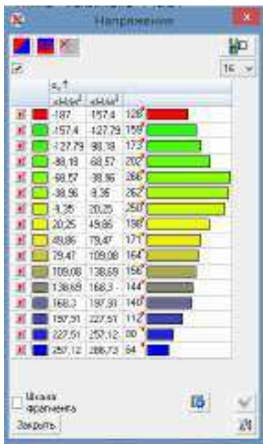
Рисунок 8.7 – Величины нормальных напряжений, кН/м 2 при действии нагрузки, соответствующей 1 ступени нагружения (толщина ребер 27 мм)
