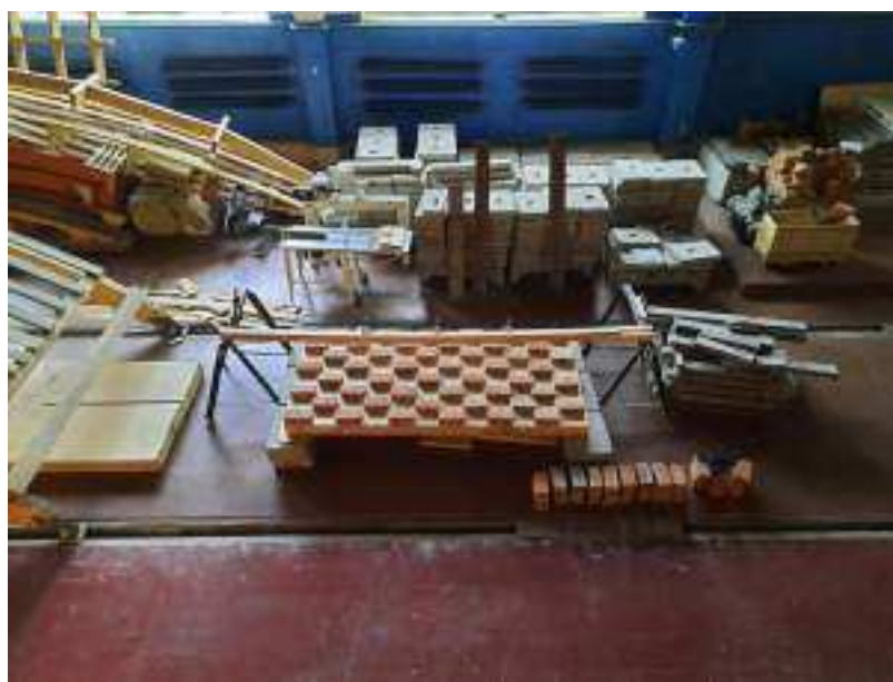
Рисунок 10.18 – Нагружение конструкции. Ступень 1. Вид 1
