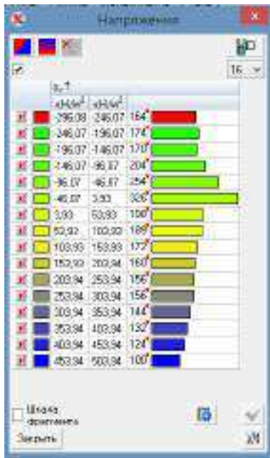
Рисунок 8.19 – Величины нормальных напряжений, \text{kH/m}^2 при действии нагрузки, соответствующей 1 ступени нагружения (толщина ребер 45 мм)
