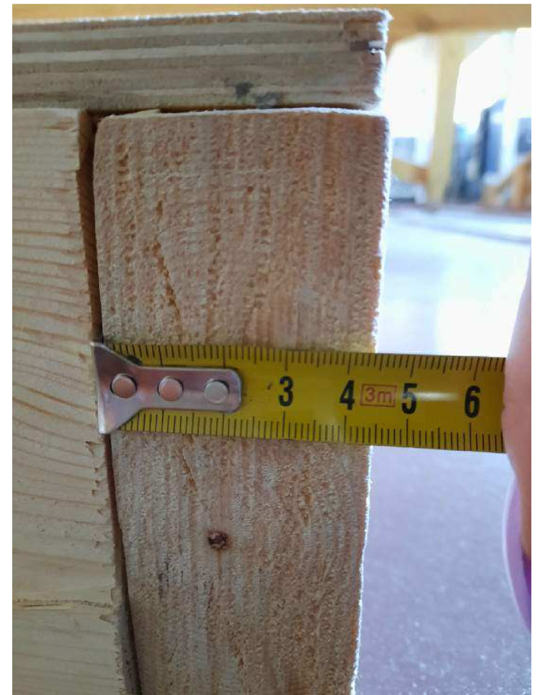
Измерение ширины продольных ребер (ребра 45 мм)
