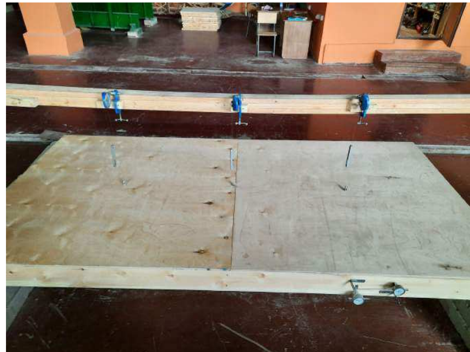
Установка прогибомеров Аустова БПАО в трех характерных точках плиты
