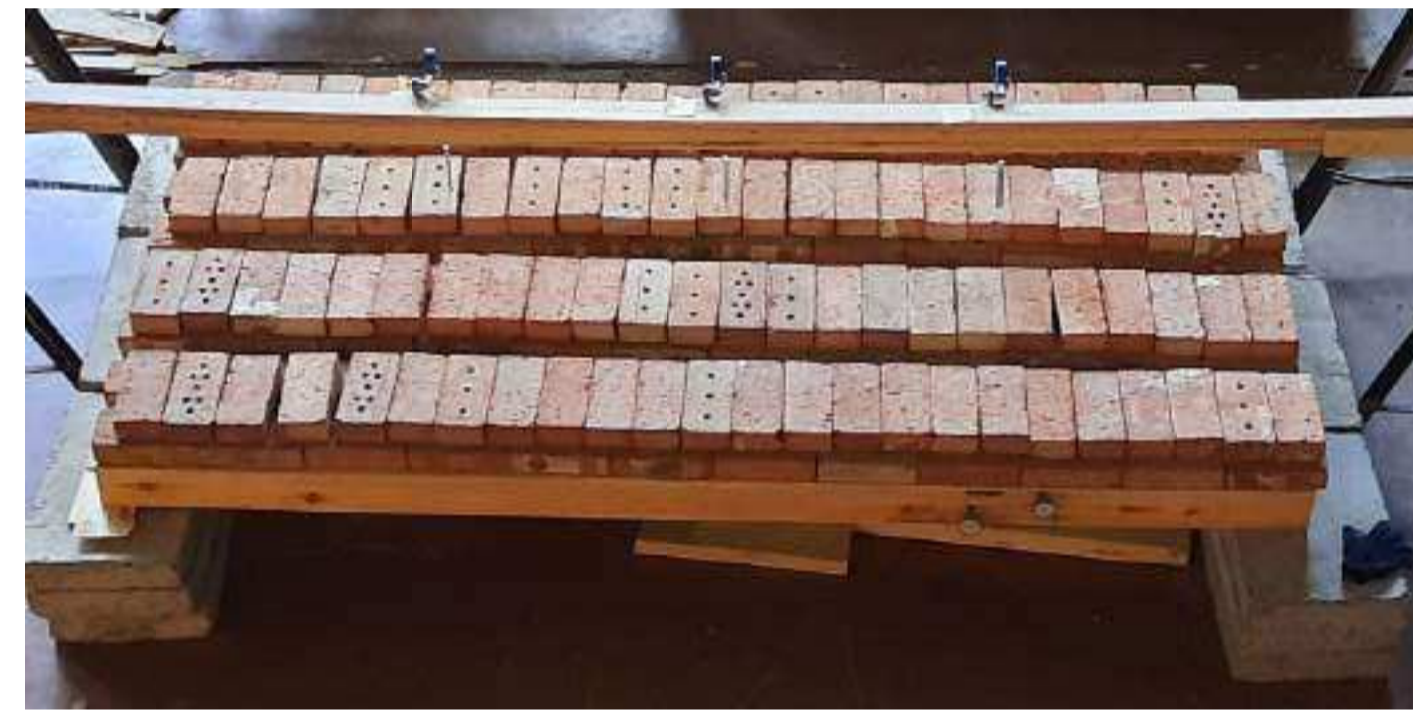
Четвертая ступень нагружения: нагрузка 1,36 кПа
