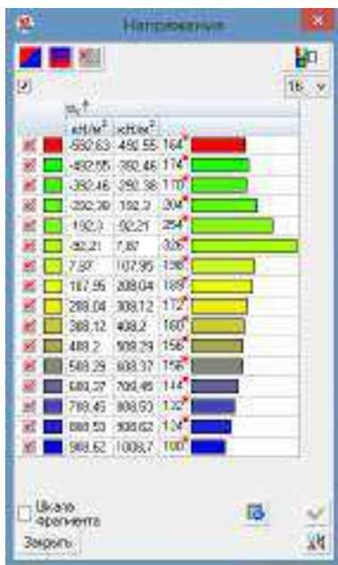
Рисунок 8.20 – Величины нормальных напряжений, \text{kH/m}^2 при действии нагрузки, соответствующей 2 ступени нагружения (толщина ребер 45 мм)
