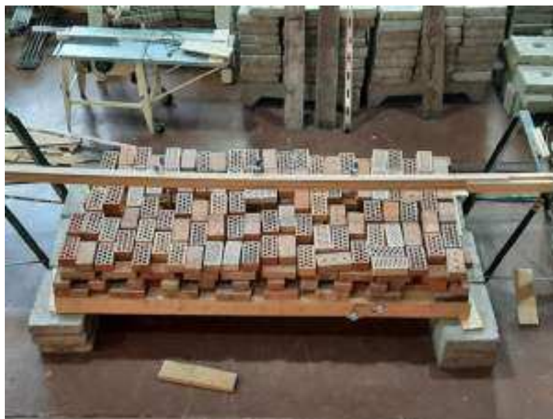
Рисунок 10.36 – Нагружение конструкции. Ступень 4. Вид 2
