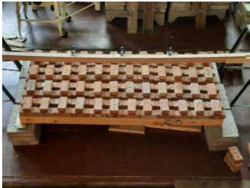
Рисунок 10.22 – Нагружение конструкции. Ступень 3. Вид 1
