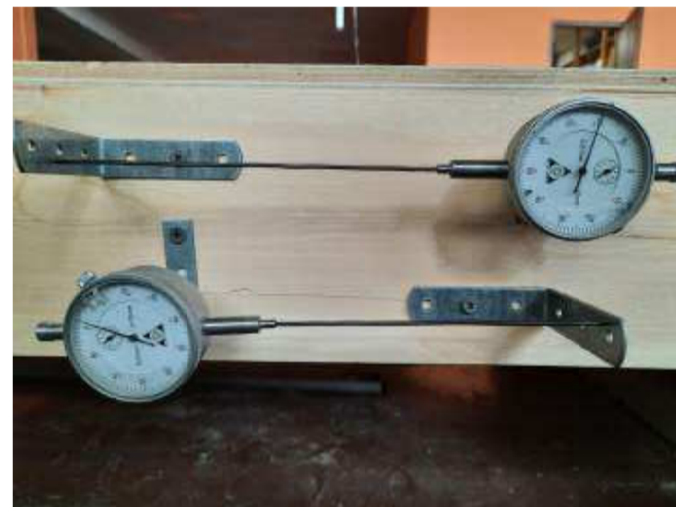
Установка индикаторов часового типа ИЧ10 на участке №2
