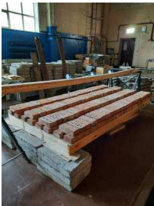
Рисунок 10.25 – Нагружение конструкции. Ступень 4. Вид 2
