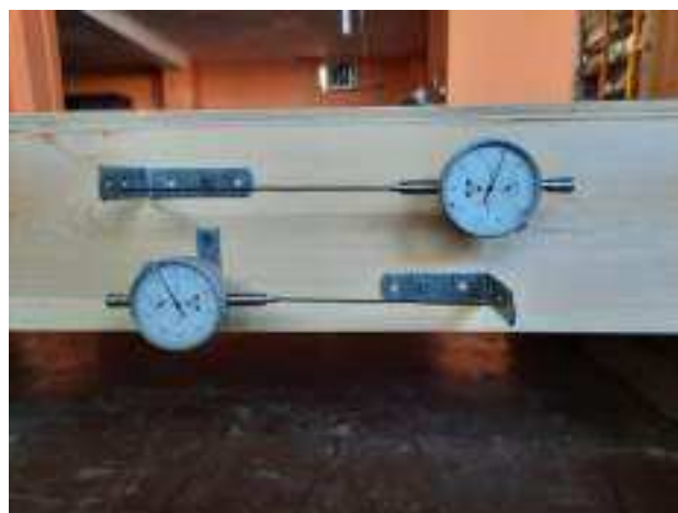
Рисунок 10.17 – Индикаторы часового типа, установленные на участке №2
