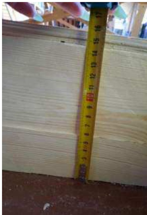
Рисунок 10.8 - Измерение высоты плиты (толщина продольного ребра 45 мм)
