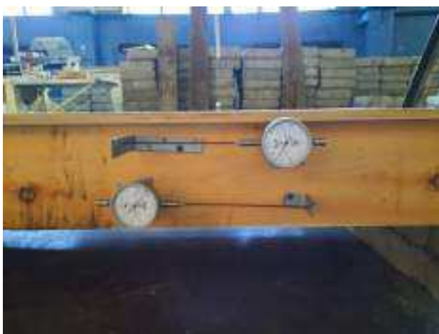
Рисунок 10.16 – Индикаторы часового типа, установленные на участке №1
