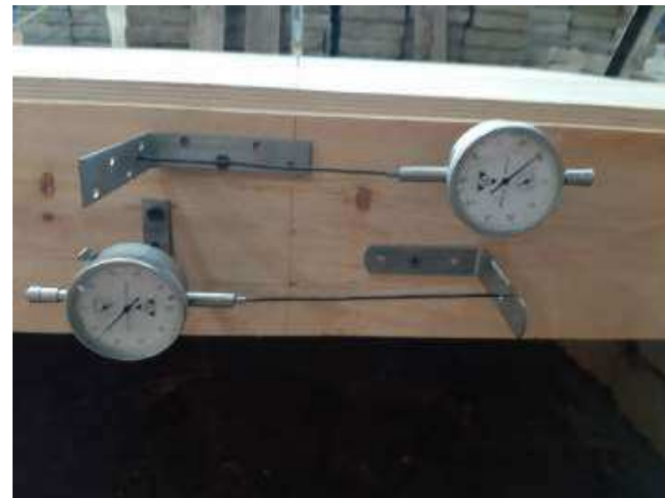
Установка индикаторов часового типа ИЧ10 на участке №1
