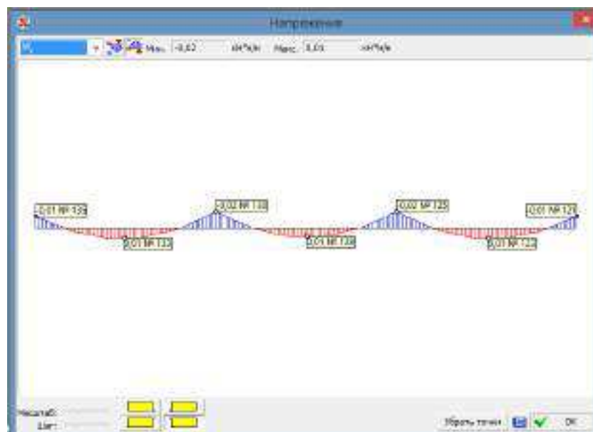
Рисунок 8.13 – Величины нормальных напряжений, \text{kH}\cdot\text{м}^2 при действии нагрузки, соответствующей 3 ступени нагружения (толщина ребер 27 мм)
