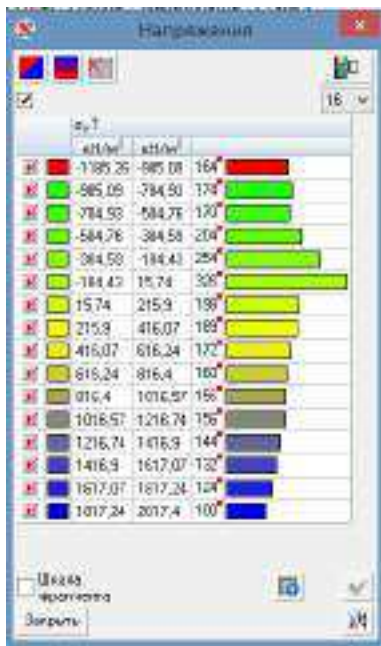
Рисунок 8.22 – Величины нормальных напряжений, кН/м 2 при действии нагрузки, соответствующей 4 ступени нагружения (толщина ребер 45 мм)
