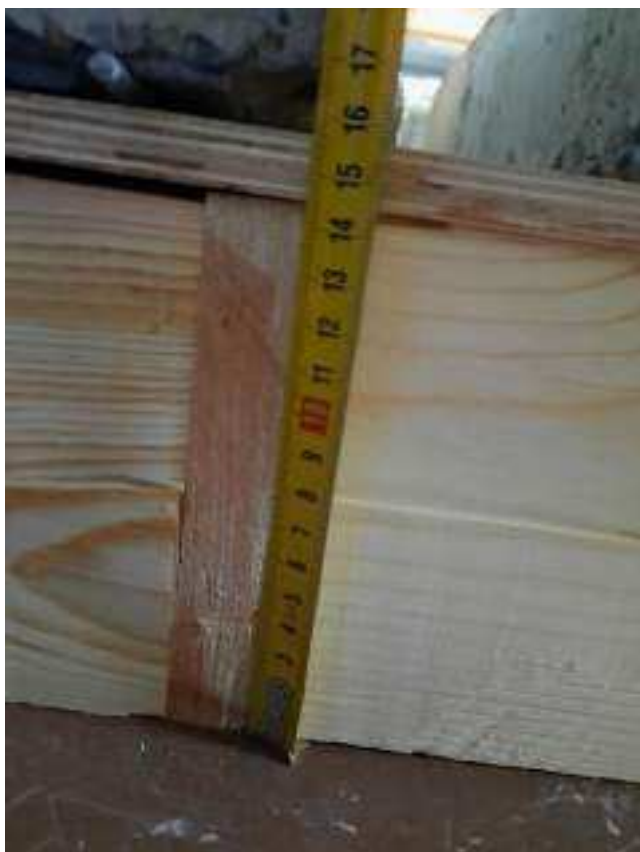
Рисунок 10.7 – Измерение высоты плиты (толщина продольного ребра 27 мм)
