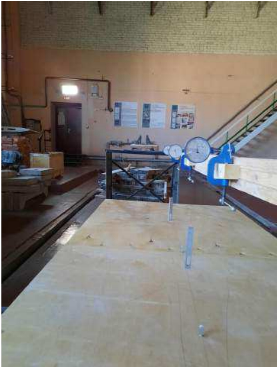
Рисунок 10.14 – Установленные прогибомеры Аистова. Вид 1
