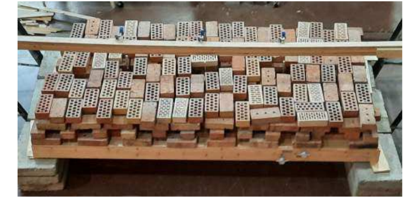
Четвертая ступень нагружения: нагрузка 2,47 кПа
