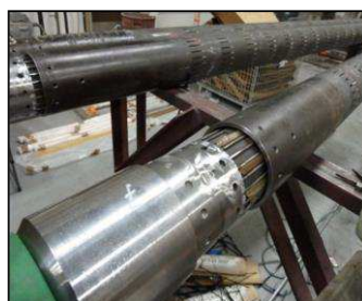
Рисунок 3.15 - Установка полимерных матриц с индикаторами притока в патрубок
