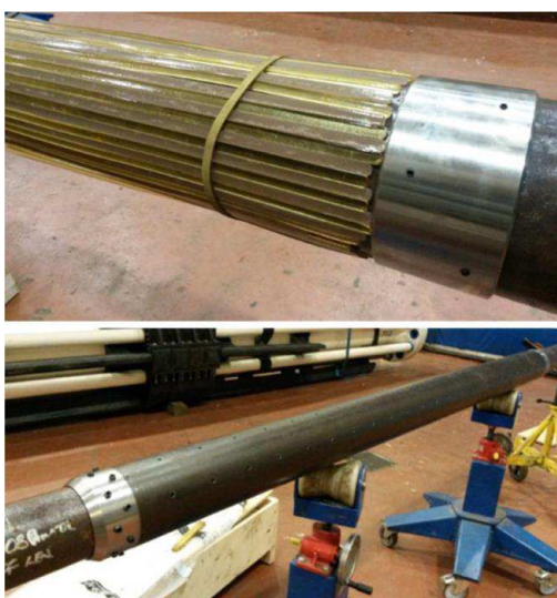
Рисунок 3.20 - Установка полимерных матриц с интеллектуальными индикаторами притока в носители с перфорированным кожухом
