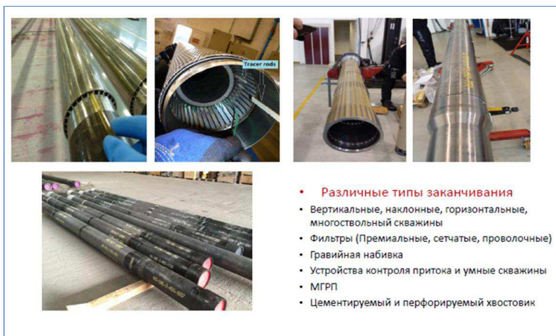
Рисунок 3.19 – Установка маркеров притока в системы заканчивания
