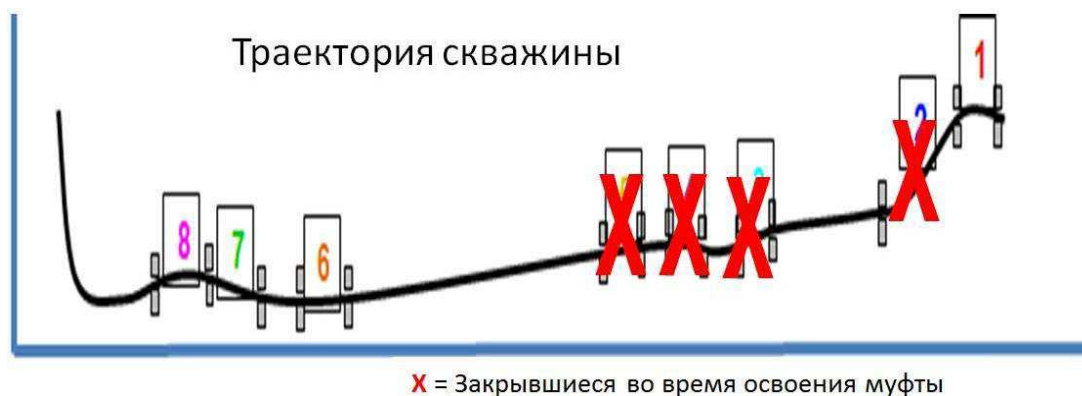
Рисунок 3.17 - Определение неработающих интервалов во время освоения скважины для закачивания со сдвижными муфтами
