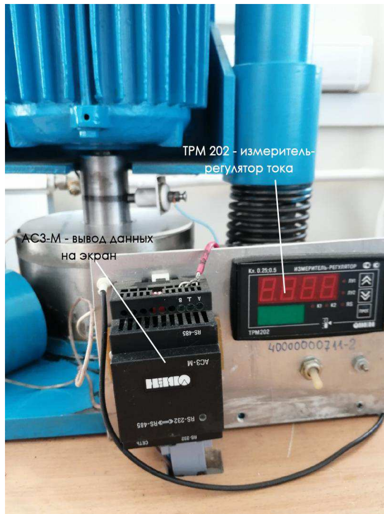
Рисунок 12 – ТРМ 202 измеритель – регулятор тока, АС3–М – вывод данных на экран.
