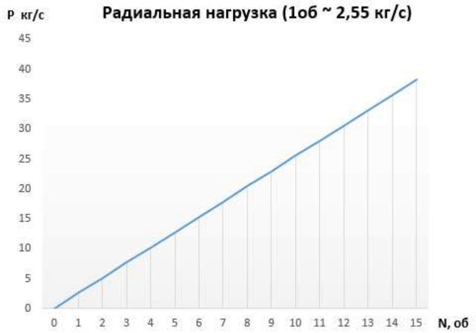
Рисунок 17 – Графики зависимости радиальной нагрузки от оборотов регулировочного болта
