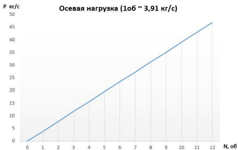
Рисунок 16 – График зависимости осевой нагрузки от оборотов регулировочного болта
