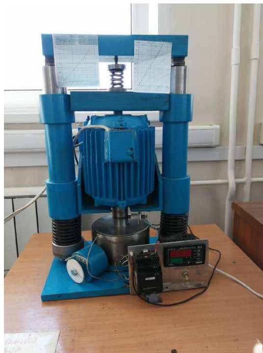
Рисунок 11 – Устройство для диагностики подшипников качения
