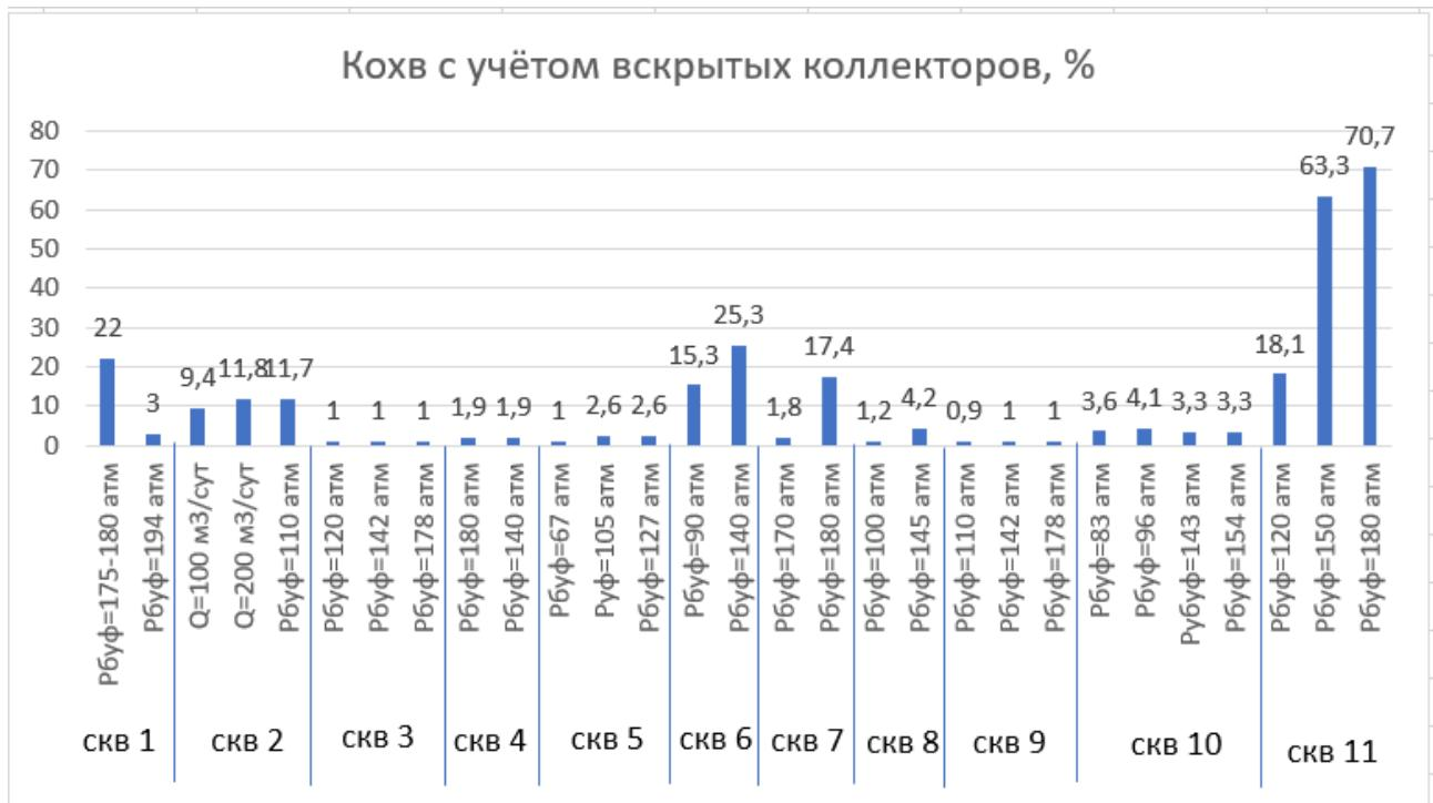
Рисунок 32 – Статистика воздействия закачки на пласт Нх-III-IV с учетом вскрытых коллекторов
