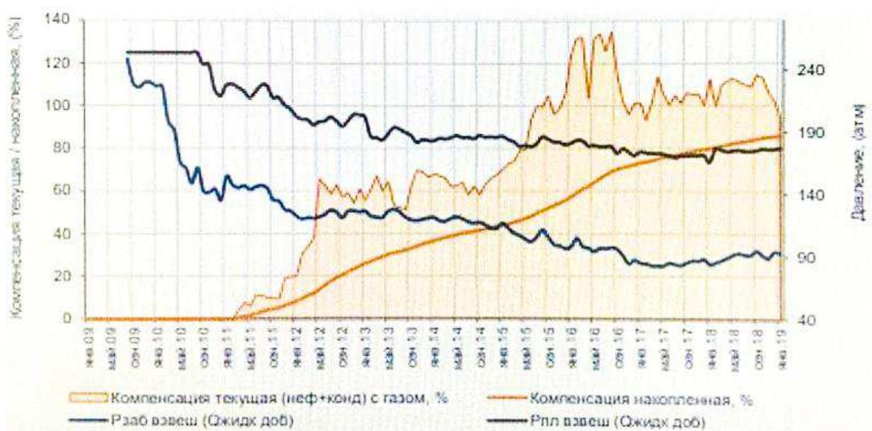
Рисунок 23 – Накопленная и текущая компенсация добычи в процессе разработки объекта Нх-И
