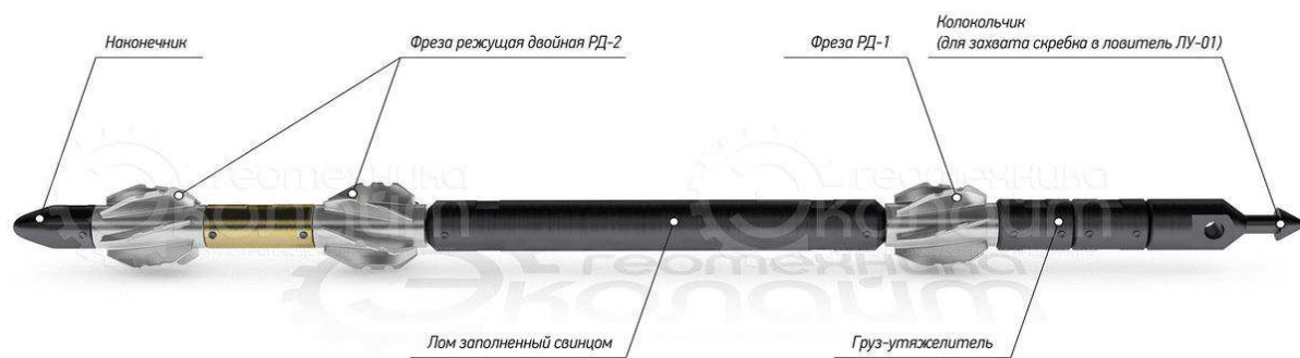
Рисунок 3.3 – Скребок режущий фрезовой для механической очистки (колонны НКТ 60, 73 и 89 мм).
