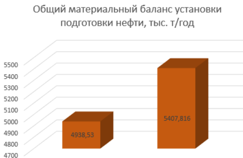
Рисунок 4.4 – разница общего материального баланса установки подготовки нефти для более вязкой нефти (слева) и менее вязкой нефти (справа)
