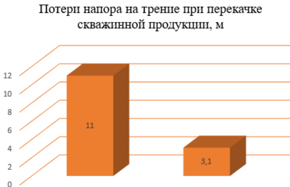
Рисунок 4.1 – Сравнение потерь напора на трение при перекачки высоковязкой нефти (слева) и маловязкой нефти (справа)
