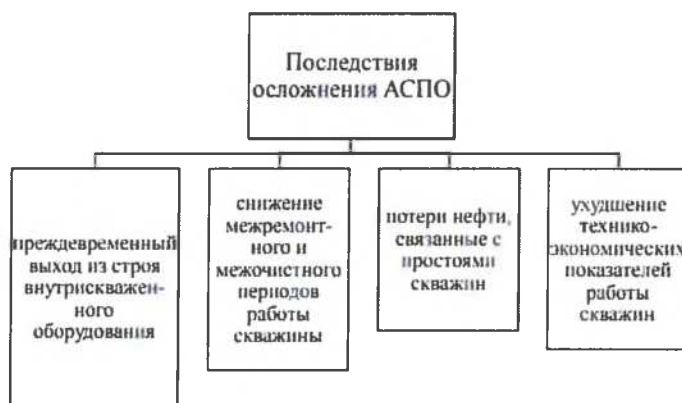
Рисунок 2.4 – Осложнения при наличии АСПО
