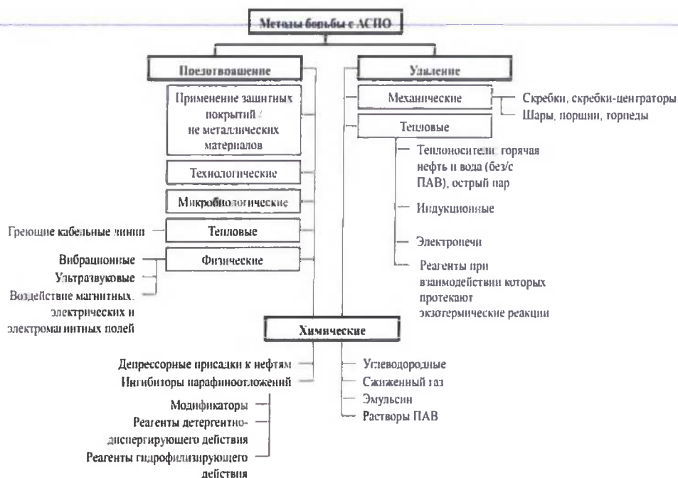
Рисунок 2.5– Схема классификации методов предупреждения
