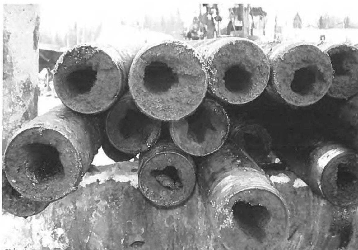
Рисунок 2.2 – Выпадение АСПО в НКТ диаметром 73мм
