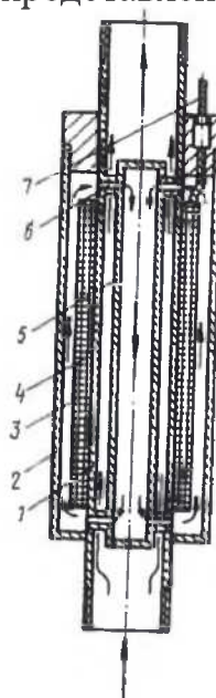
1 – корпус, 2 – стальной кожух, 3 – полость, 4 – индукционные катушки, 5 – полый сердечник, 6 – каналы, 7 – электрокабель питания [78]
