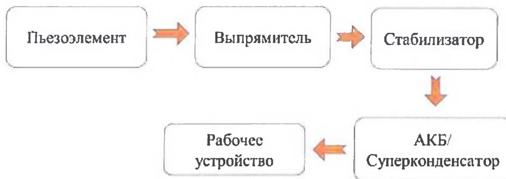
Рисунок 1.8 – Принципиальная схема системы автономного электроснабжения скважинных устройств
