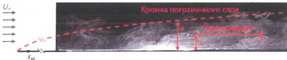
Рисунок 3.8 – Визуализация потока на границе турбулентного слоя
