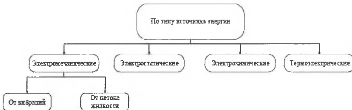
Рисунок 1.3 – Классификация скважинных генераторов по типу источника энергии
