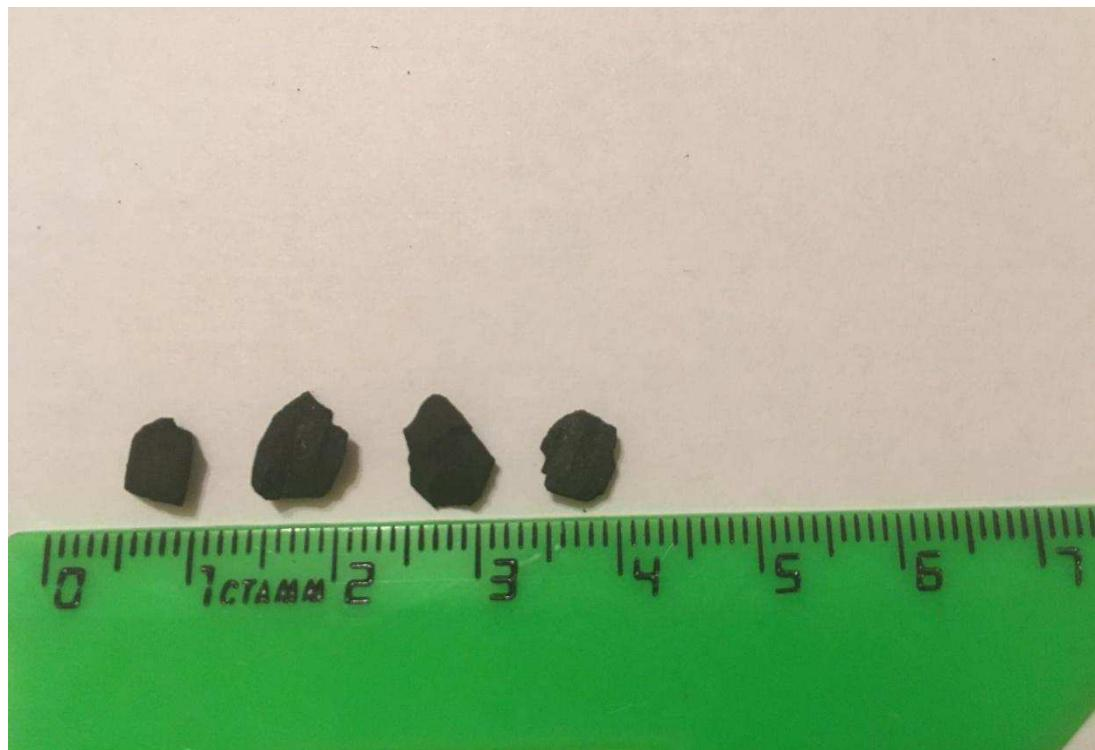
Рисунок 10 – Размер гранул получаемого нановолокнистого углерода
