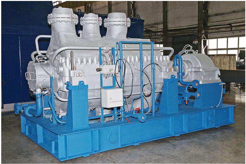
Рисунок 18. Центробежная компрессорная установка с горизонтальным разъемом корпуса.
