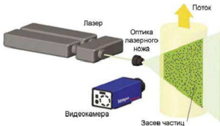
Рисунок 1 - Принципиальная схема работы измерительного комплекса лазерной трассерной визуализации
